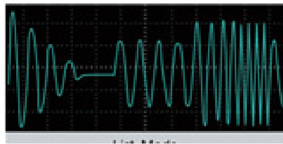
Режим изменения напряжения по списку
