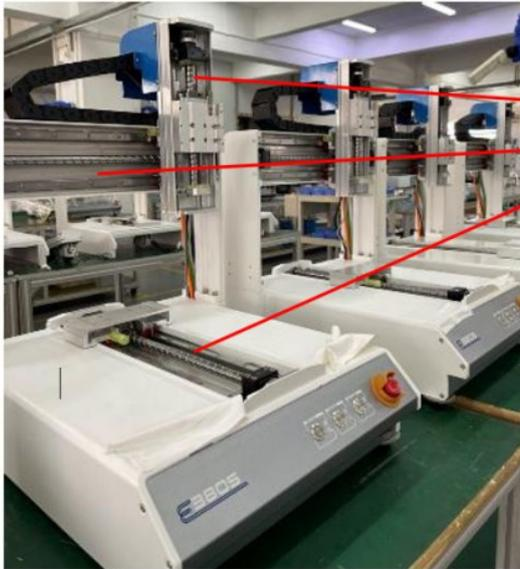
Оси E380S и E480S XYZ используют ходовые винты и серводвигатели в качестве транспортной системы. Движение ходового винта более точное, стабильное и прочное по сравнению с шаговыми двигателями и ремнями.
