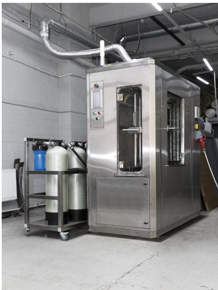
**Подвижная платформа для быстрой смены картриджей водоподготовки.** Установка имеет выкатную платформу с регенерирующими колоннами (уголь и ионообменная смола), которая позволяет оперативно заменить картриджи водоподготовки и провести техническое обслуживание системы.
