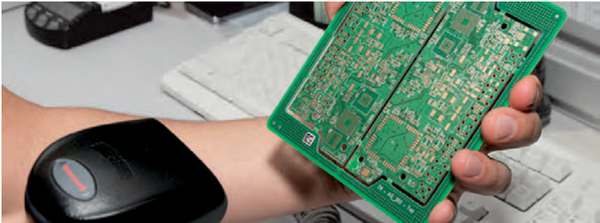
Рис. 1. Пример инициализации платы в системе перед сборкой на линии
