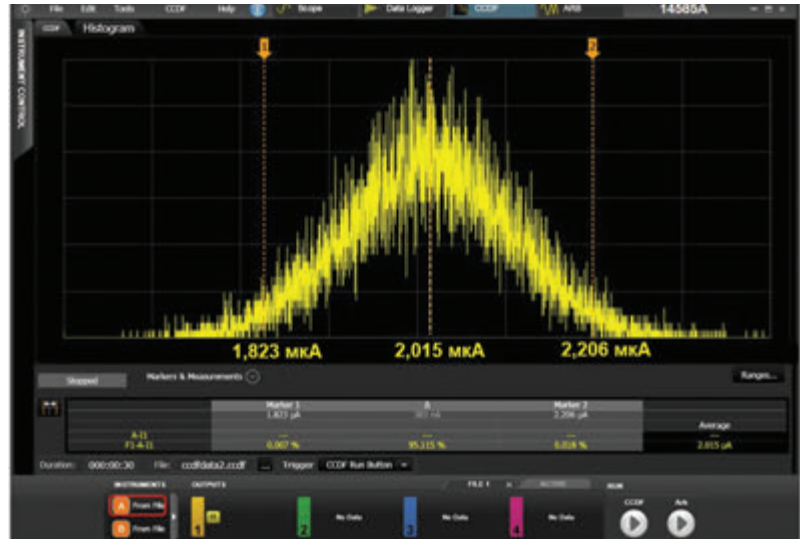
Рис. 4. Пример гистограммы распределения результатов измерений тока утечки
