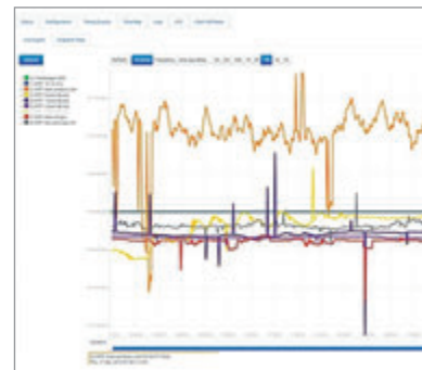
Рис. 2. Сравнение интернет-серверов времени с локальным GPS-сервером. Шкала в 1000 раз больше, чем на рис. 1
