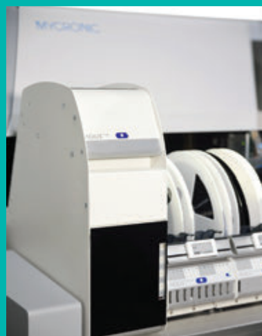
Магазин ATM: малые и средние серии, компактный (восемь поддонов на один слот)
