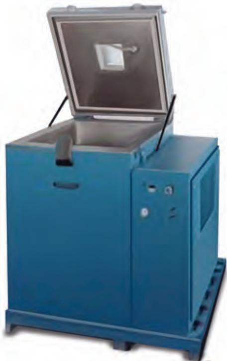
Камеры компании Thermotron предназначены для испытания стойкости продукта на воздействие песка и пыли в условиях сильного запыления, аналогичных пустыне, и удовлетворяют стандартам для тестирования автомобилей.
