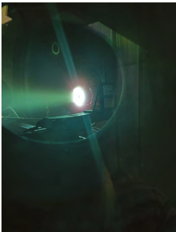
Рис. 1. Испытания в вакуумной камере двигателя с эффектом Холла мощностью 10 кВт (500 В/20 А)
