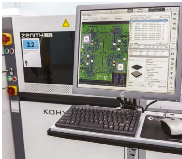
Koh Young Zenith Lite — автоматическая измерительная 3D-система для обнаружения дефектов, сбора данных и статистического анализа
