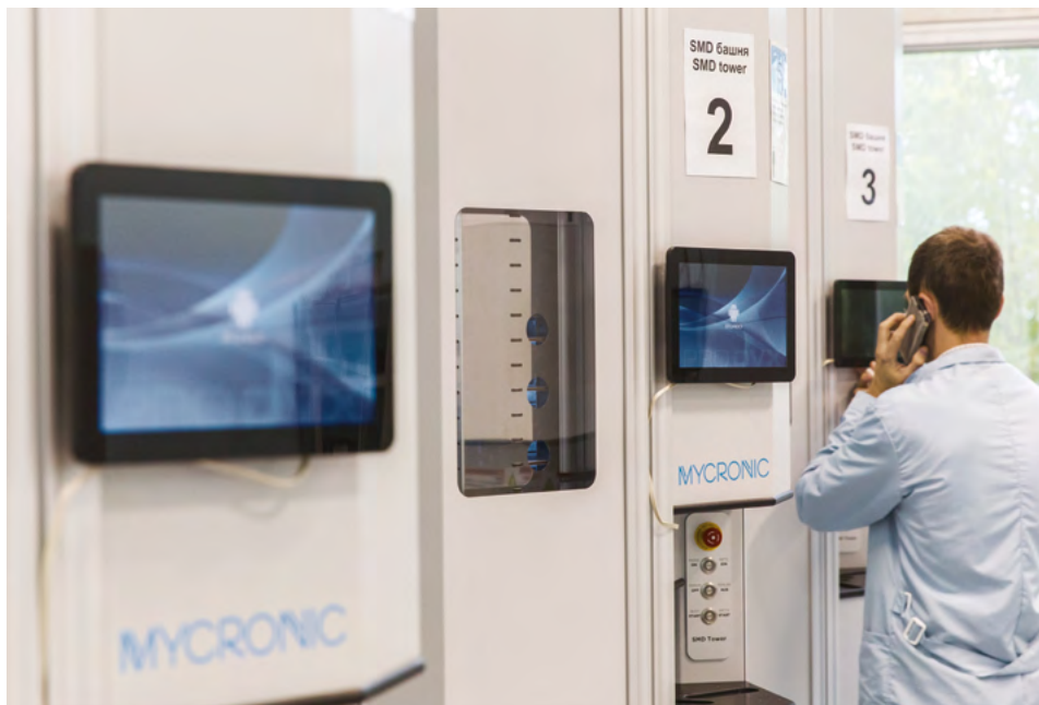
Интеллектуальные автоматизированные системы хранения SMD Tower (производитель Mycronix)
