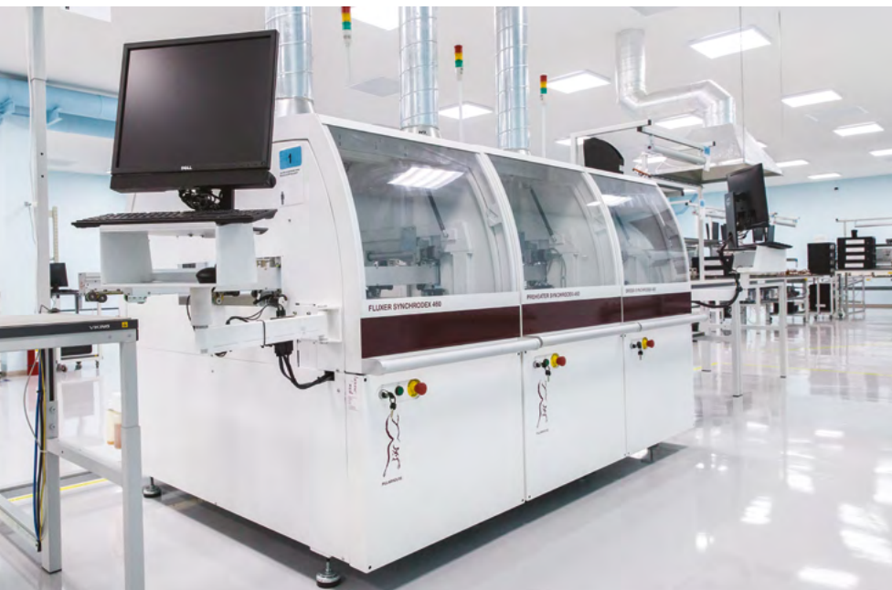
Высокопроизводительная линия селективной пайки Synchrondex (производитель Pillarhouse)
