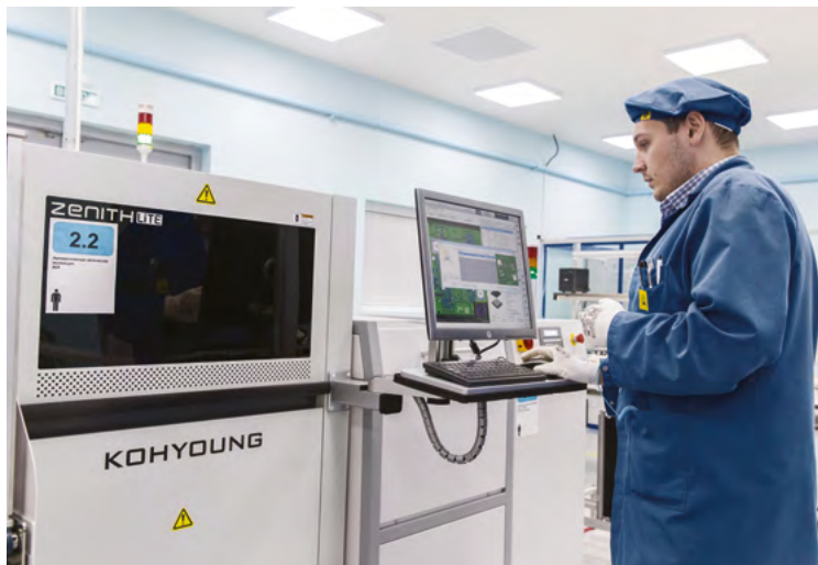
Koh Young Zenith Lite — автоматическая измерительная 3D-система для обнаружения дефектов, сбора данных и статистического анализа
