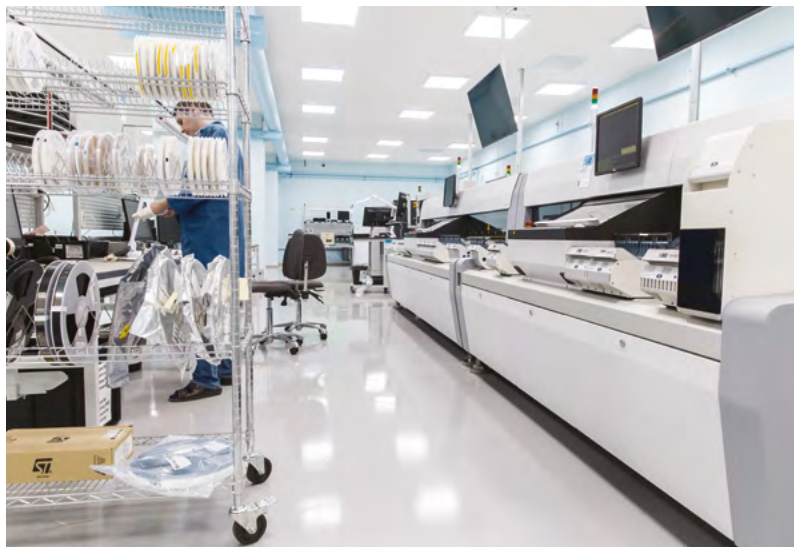
Полностью автоматическая гибкая высокоточная линия поверхностного монтажа
