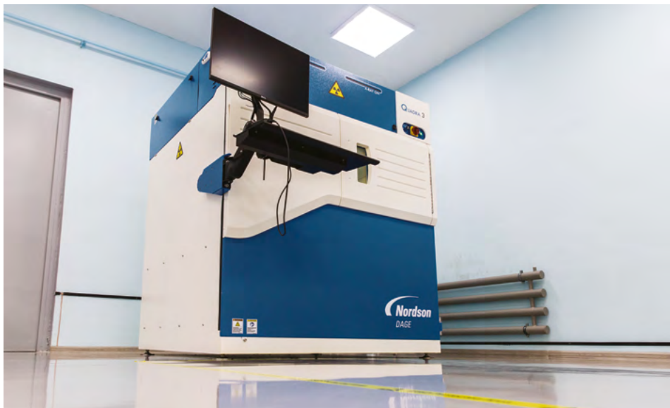
Новейшая высокоэффективная система рентгеновского контроля Quadra 5 (производитель Nordson dage) для проверки собранных изделий на скрытые дефекты
