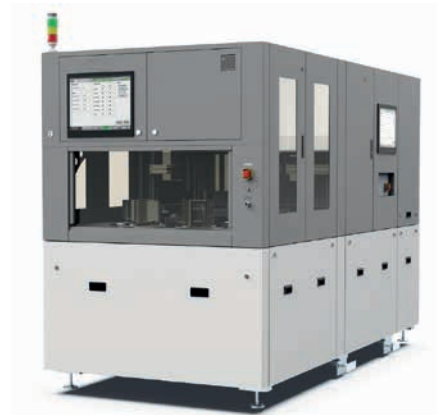
Аналог установки утонения Disco DFG8540 (Ø100-200 мм, fine/coarse grinding)
