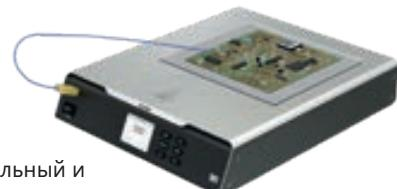
Внимание: положительный и отрицательный полюса термопары типа K должны соответствовать положительному и отрицательному полюсам на панели аппарата.
