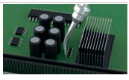
Можно выбрать паяльный наконечник в соответствии с потребностями, чтобы легко справляться с пайкой больших паяных соединений. (Паяльный наконечник в форме желобка обеспечивает достаточное количество флюса для пайки)
