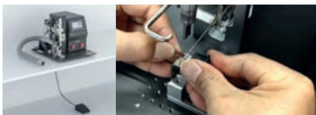
Можно использовать в сочетании с приспособлениями для автоматической пайки, уменьшая неровности при ручной пайке и повышая стабильность качества пайки. Для удобства управления можно подключить к внешней педали управления.
