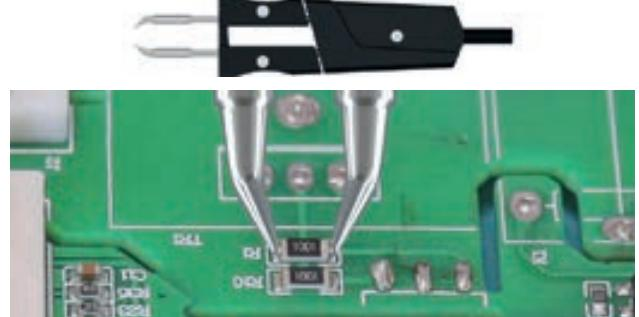
Электрический пинцет 100 Вт используется для пайки и демонтажа различных устройств SMD (компоненты поверхностного монтажа).
