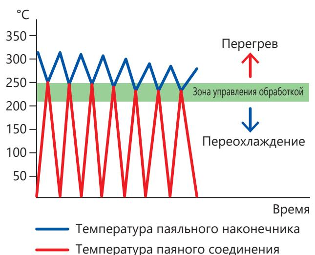
Каждое паяное соединение может быть выполнено в зоне управления обработкой для предотвращения холодной пайки!
