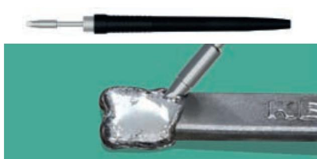
Паяльник мощностью 150 Вт используется для пайки больших площадок и крупных деталей.
