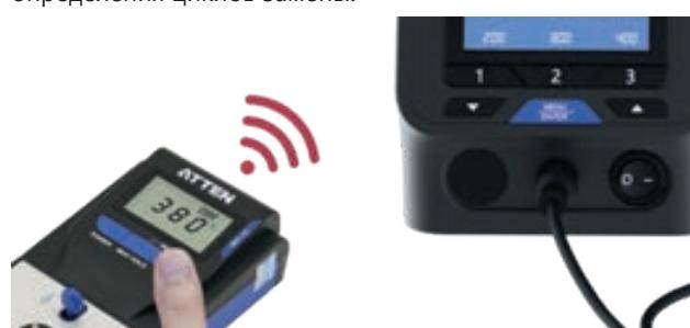
В сочетании с паяльной станцией Atten (с функцией инфракрасного излучения) можно выполнить калибровку температуры нажатием одной кнопки.
