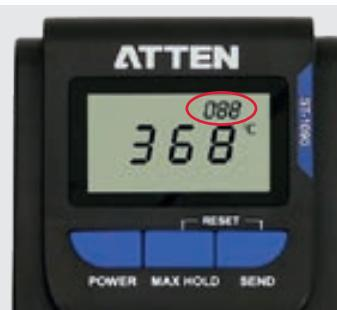
Отображение числа измерений температуры и запись текущего использования датчика для легкого определения циклов замены.
