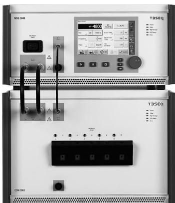
Если NSG 3040 работает с 3043 CDN, то 3-фазная связь работает по умолчанию активна в том смысле, что импульсы перенапряжения и БПП будут связываться в CDN 3043, в то время как тест PQT можно провести с выхода ИО на NSG 3040. Тест PQT можно проводить без отключения или переключения CDN 3043 (внутренний CDN устройства NSG 3040 называется CDN 3041).
