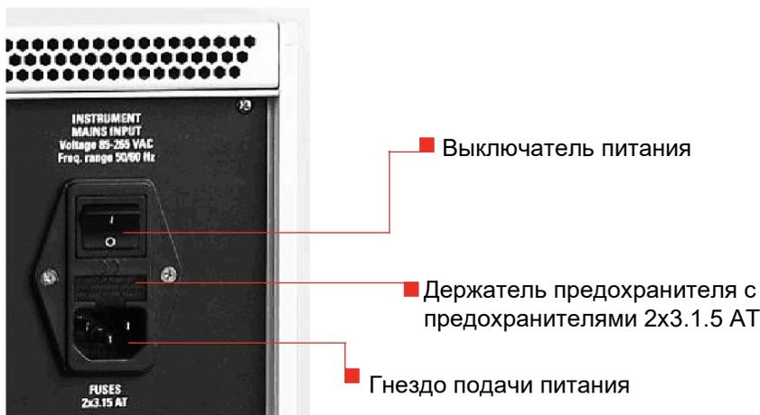
Для того чтобы вставить предохранитель, выньте держатель предохранителя из разъема, вставьте два предохранительных картриджа 2 x 3.15 АТ (медленно перегорающие предохранители) в держатель, затем вставьте держатель на место.
