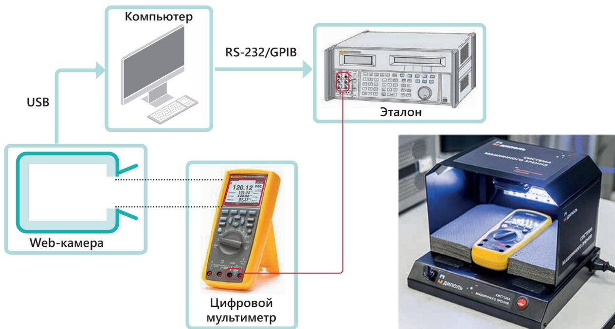
Подключение IP-камер дает возможность работы на расстоянии и, как следствие, в экстремальных условиях.
