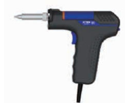
Демонтажный пистолет GT-X151 (Стандартные паяльные наконечники T151-0.8, T151-1.0, T151-1.3, T151-1.6) Подробное описание демонтажных сопел серии T151 см. на стр. 05. Примечание: пистолет для отсоса олова GT-X151, диапазон температур: 350–480 °C.
