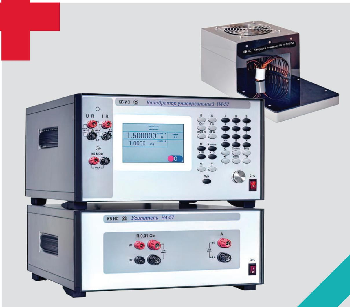
Калибратор универсальный Н4-57 это прецизионное генерирующее устройство, предназначенное для осуществления калибровки и поверки средств измерений электрических величин. Состоит из двух переносных блоков. В комплект поставки может входить катушка токовая предназначенная для поверки токовых клещей.
