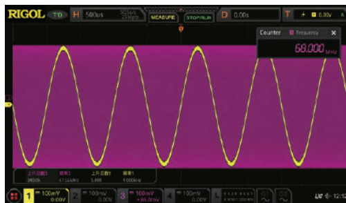
Измерение частоты встроенным частотомером
