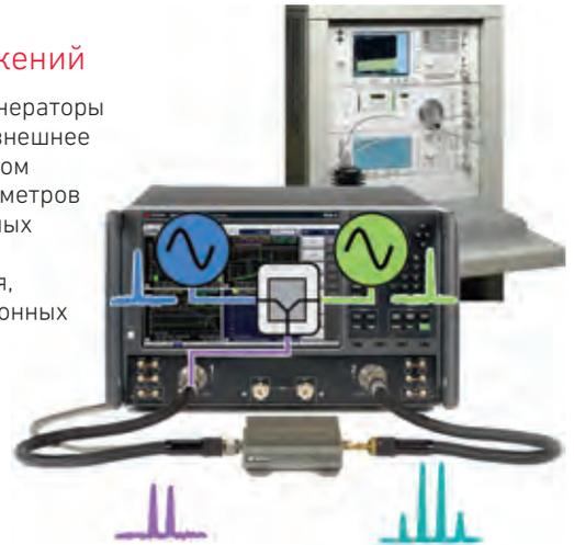
PNA-X с приложением IMD заменяет два генератора сигналов и анализатор спектра в системной стойке, упрощая конфигурацию системы и увеличивая производительность испытаний.
