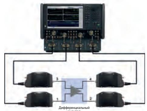
Измерение параметров балансного усилителя напряжения, управляемого током, с использованием реальных дифференциальных сигналов с помощью 4-портового анализатора цепей серии PNA, контроллера N5292A и модулей расширения частотного диапазона N5293A.
