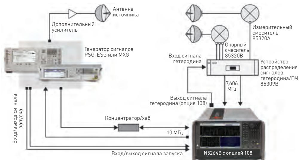
Измерительный приёмник PNA-X, сконфигурированный для измерения параметров антенн в дальней зоне. Можно также использовать PNA-X с опцией 020 (входы ПЧ).
