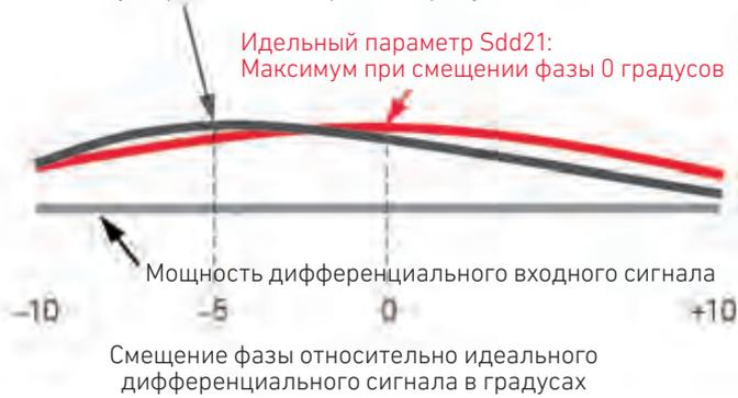
Измерение TУ со свипированием смещения фазы в тестовой оснастке позволяет выявить оптимальное значение смещения фазы для достижения наивысшего коэффициента усиления, что крайне необходимо при разработке входной схемы согласования.
