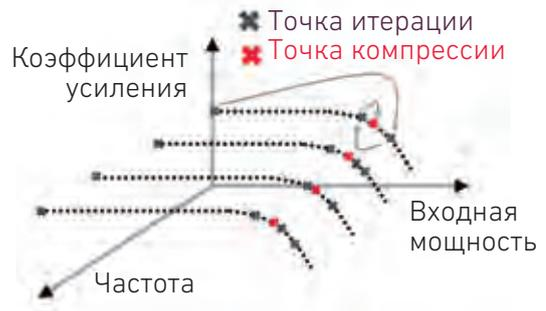
Для измерения компрессии коэффициента усиления с помощью анализатора цепей обычно используется свипирование уровня мощности на нескольких частотах НГ-сигнала. Приложение GCA анализаторов цепей PNA-X упрощает определение характеристик компрессии в пределах рабочего диапазона частот ТУ за счёт исключительно высокой скорости, точности и простоты настройки параметров измерения.
