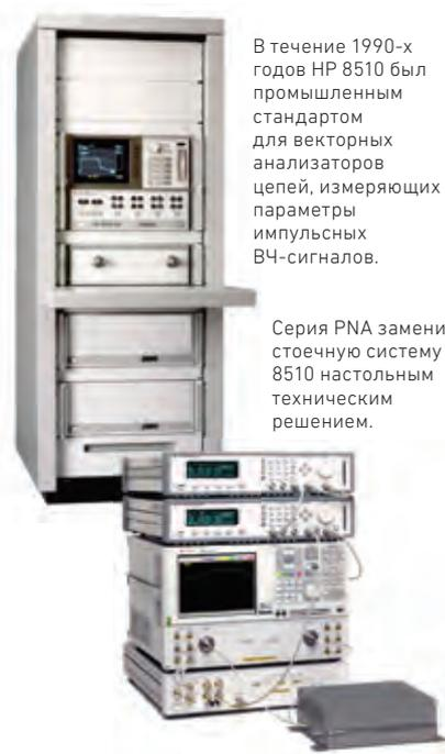
В течение 1990-х годов HP 8510 был промышленным стандартом для векторных анализаторов цепей, измеряющих параметры импульсных ВЧ-сигналов.
