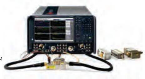
Класс скалярных измерений смесителей/ преобразователей частоты плюс фазы (SMC+Phase) приложения S93083A упрощает установку измерений смесителей и преобразователей частоты, так как опорный и калибровочный смеситель не требуются. Калибровка легко выполняется с использованием трёх широкополосных мер: измерителя мощности в качестве меры уровня мощности, генератора комбинационных частот в качестве меры фазы и калибровочного комплекта S-параметров (механического или модуля ECal).
