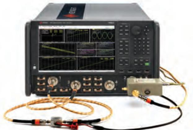
Программные приложения NVNA и принадлежности превращают 4-портовый анализатор цепей PNA-X компании Keysight в высокопроизводительный анализатор для нелинейного векторного анализа цепей.
