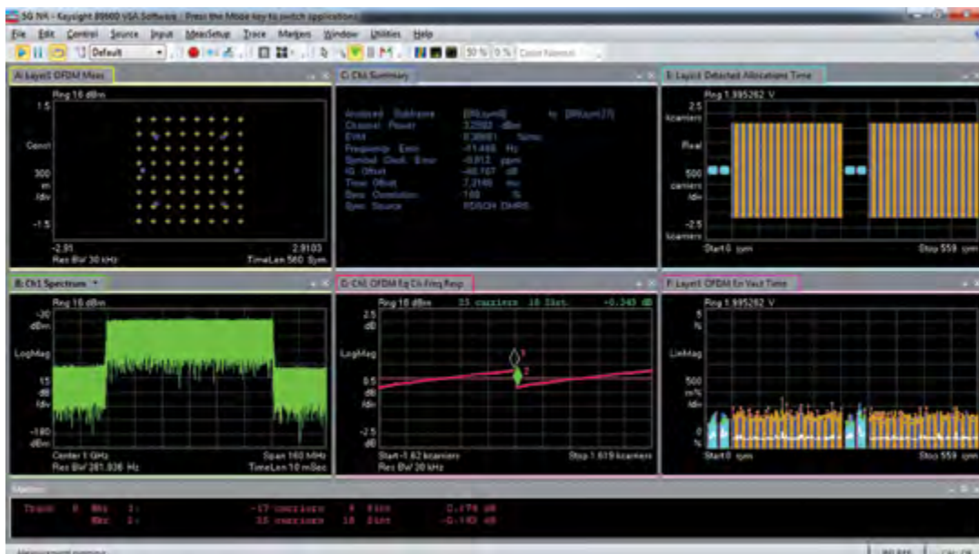
Измерение сигнала 5G NR с включенной внутренней коррекцией канала
