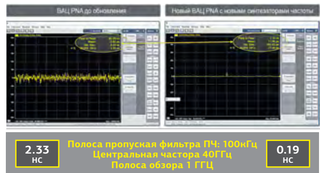
Измерение ГВЗ смесителя с использованием приложения для измерения скалярных параметров и фазы преобразователей частоты (SMC+phase)
