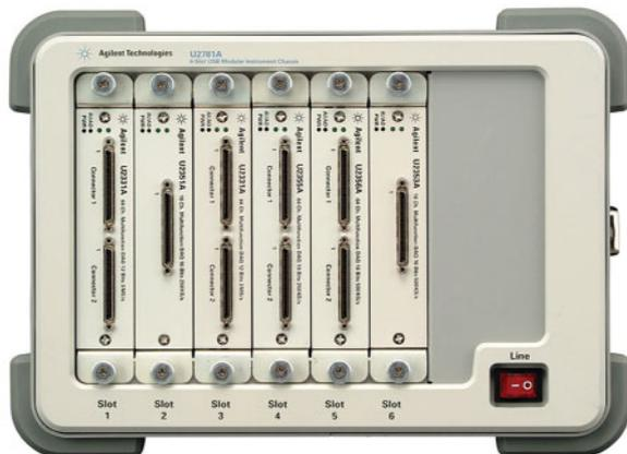
Базовый блок модульных приборов U2781A с размерами 250 мм (ширина), 177 мм (высота) и 271 мм (глубина) имеет шесть гнезд для установки модулей серии U2300A с интерфейсом USB. Системообразующей шиной в U2781A является шина USB. Данное техническое решение расширяет диапазон предложений компании Agilent в области систем сбора данных на основе ПК, используемых на этапах НИОКР, производства и аттестации изделий.
