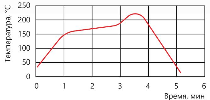
Приводимые рекомендации по профилю применимы к большинству сплавов Sn/Pb, включая Sn/Pb/Ag. Эти данные можно использовать в качестве общих рекомендаций при установке профиля оплавления для сплавов Sn/Pb. Отклонение от этих рекомендаций возможно, и может быть необходимым, в зависимости от конкретных технологических требований, включая размер, массу компонентов и плотность монтажа.
