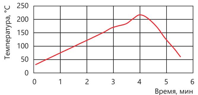
Приводимые рекомендации по профилю применимы к большинству сплавов Sn/Pb, включая Sn/Pb/Ag. Эти данные можно использовать в качестве общих рекомендаций при установке профиля оплавления для сплавов Sn/Pb. Для более подробной информации обратитесь к техническому листу на данный продукт.
