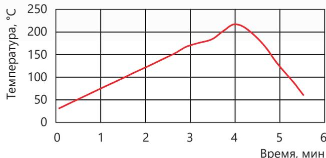
Приводимые рекомендации по профилю применимы к большинству сплавов Sn/Pb, включая Sn/Pb/Ag. Эти данные можно использовать в качестве общих рекомендаций при установке профиля оплавления для сплавов Sn/Pb. Отклонение от этих рекомендаций возможно, и может быть необходимым, в зависимости от конкретных технологических требований, включая размер, величину плотность монтажа на плате.
