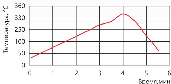
Приводимые рекомендации по профилю применимы к большинству сплавов Sn10/Pb90. Эти данные можно использовать в качестве общих рекомендаций при установке профиля оплавления для сплавов Sn/Pb. Отклонение от этих рекомендаций возможно, и может быть необходимым, в зависимости от конкретных технологических требований, включая размер, толщину и плотность монтажа на плате.
