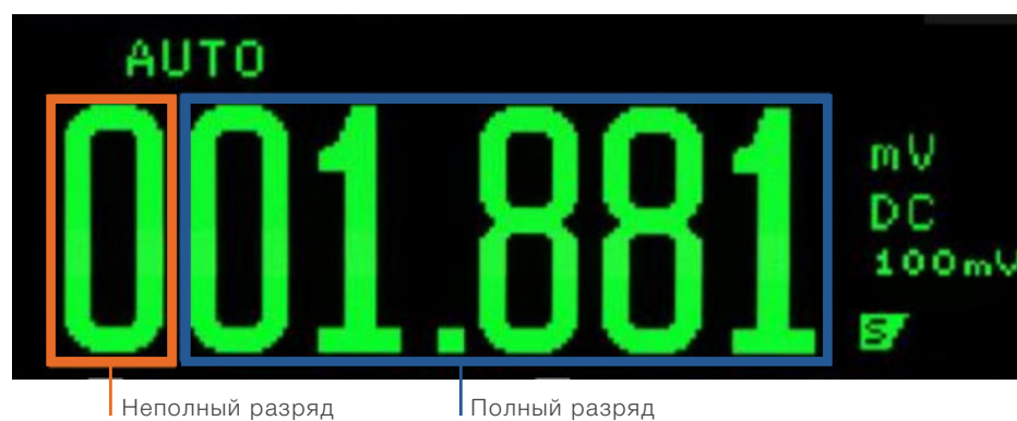
Рисунок 1. Пример цифрового дисплея мультиметра с разрядностью 5\frac{1}{2} .
