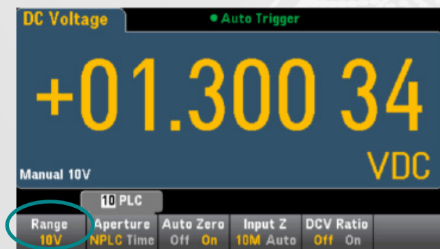
Рисунок 2. Пример показаний при измерении постоянного напряжения на пределе 10 В.
