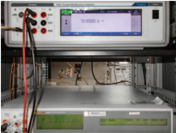
Рис. 2. Калибраторы Meatest 9000 и Calibro 143 в режиме формирования постоянного напряжения
