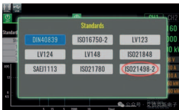
Рис. 3. Встроенные в интерфейс источников питания постоянного тока серии IT6600C библиотеки кривых имитации реальных бортовых сетей электропитания автомобилей
