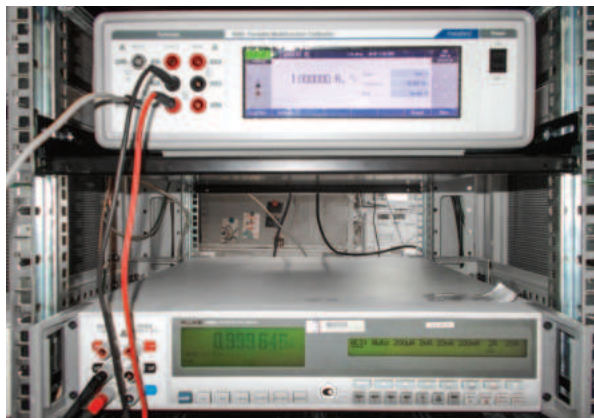
Рис. 8. Калибраторы Meatest 9000 и Calibro 143 в режиме формирования переменного тока
