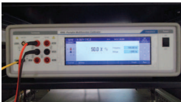
Рис. 11. Калибратор Meatest 9000 в режиме формирования прямоугольного сигнала с переменной скважностью
