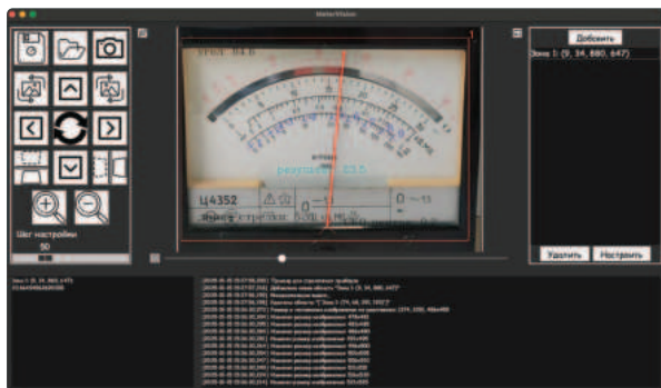
Рис. 18. Окно программы MeterVision в режиме распознавания стрелочных СИ с нелинейной шкалой. Программа также умеет распознавать цифровые дисплеи, текст и цвета
