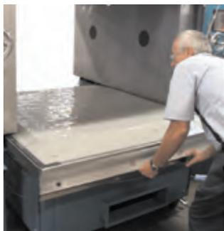
Камеры AGREE, сопряженные с ударным стендом, можно использовать для проведения ускоренных испытаний жизненного цикла (HALT) и ускоренных отбраковочных испытаний (HASS).
