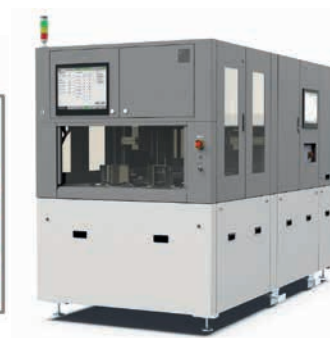
Аналог установки утонения Disco DFG8540 (Ø100-200мм, fine/coarse grinding)
