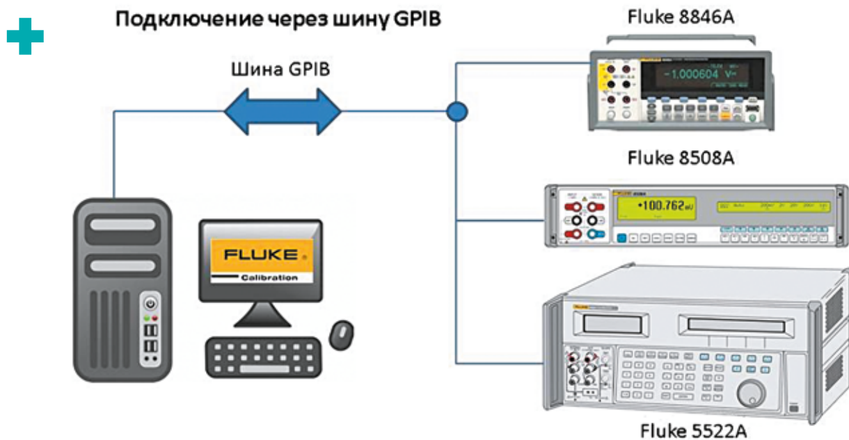
Рис. 1. Полностью автоматическая поверка СИ (один из возможных вариантов коммутации)
