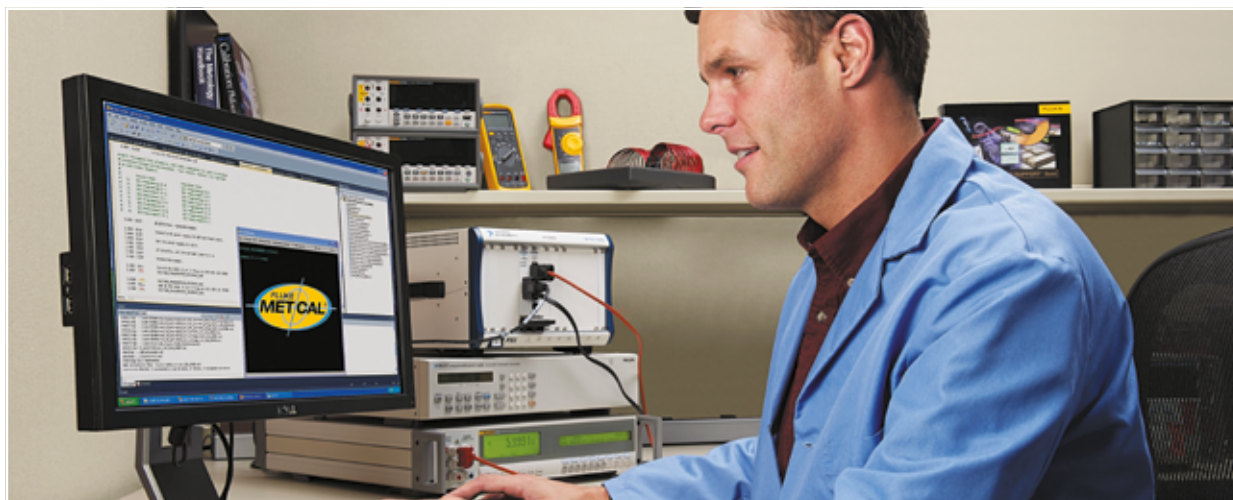
Рис. 1. Полностью автоматическая поверка СИ (один из возможных вариантов коммутации)
