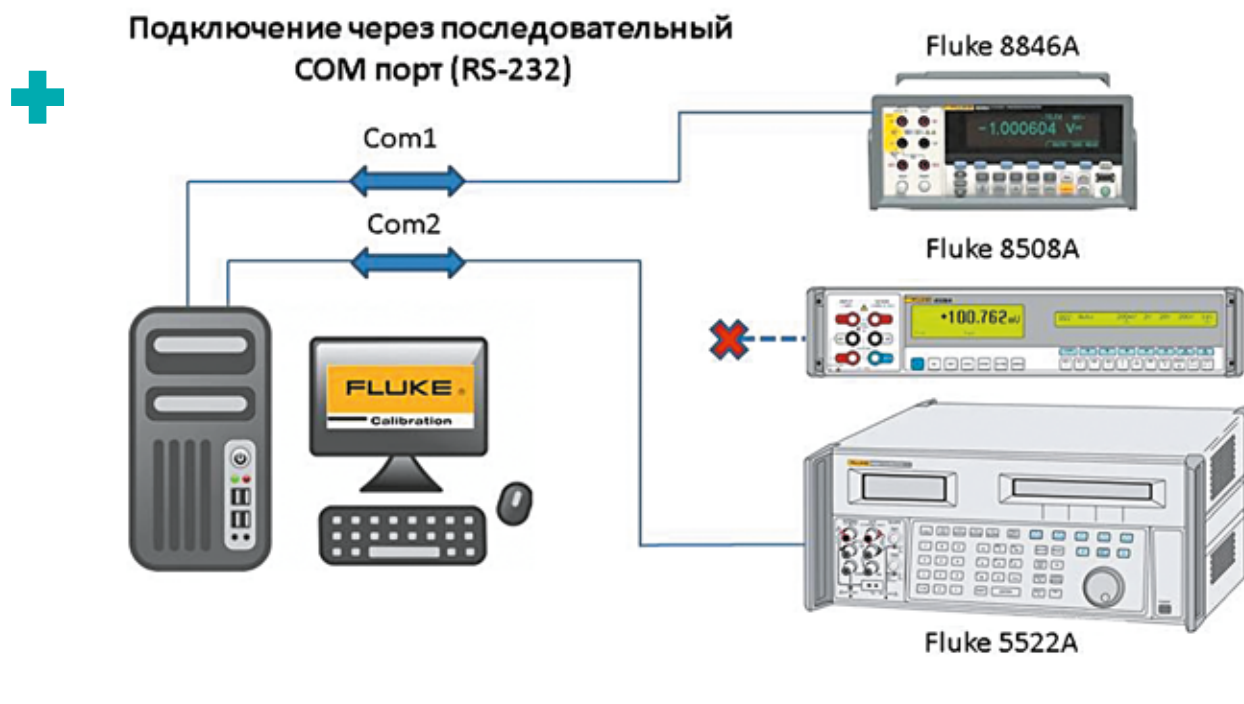
Рис. 2 Полуавтоматическая поверка СИ (один из возможных вариантов коммутации)
