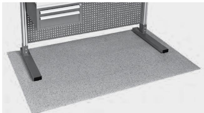
Двухслойные антистатические напольные коврики толщиной 2,5 мм, суперизносостойкие, шумопоглощающие, негорючие, термостойкие, верхний слой рассеивающий, нижний — проводящий: сопротивление относительно земли менее 1 ГОм.
