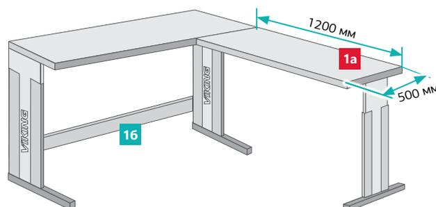
При заказе стола в ESD исполнении, необходимо заказать соединительную коробку и узел заземления.
