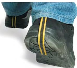
Одноразовые заземляющие полоски для обуви предназначены для временного использования. Полоска крепится при помощи липкого покрытия к подошве и размещается внутри обуви, желательно под пятку. Упаковка 100 шт.
