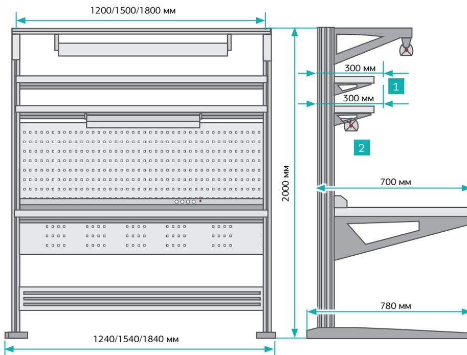
**Серия АЛЪЯНС Автоматический** — изящество конструкции, высокая эргономичность и система автоматической регулировки рабочих поверхностей по высоте, осуществляемой с помощью электропривода и пульта управления.
