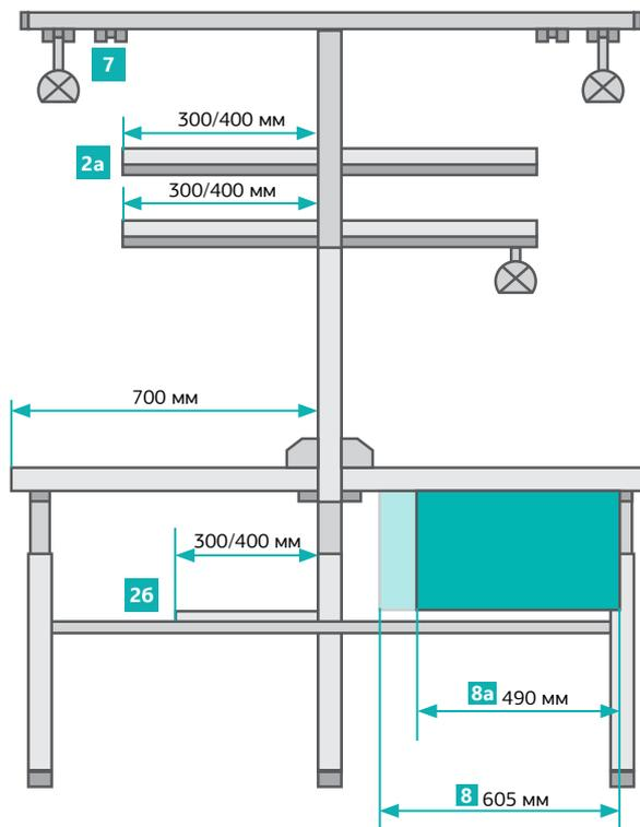
При заказе стола в ESD исполнении, необходимо заказать соединительную коробку и узел заземления.
