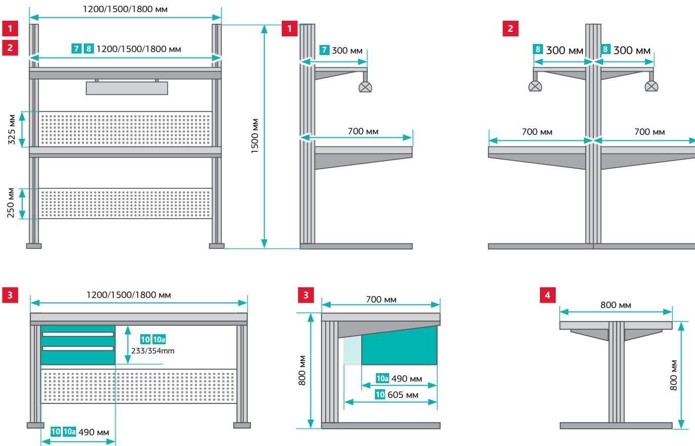
При заказе стола в ESD исполнении, необходимо заказать соединительную коробку и узел заземления.
