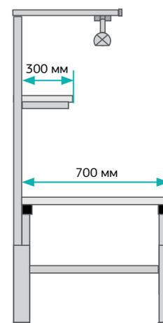
В комплект входит рабочий стол CP серии КЛАССИК, полка для оборудования ПО (глубина 300 мм), освещение ДЛ/А со светильником в алюминиевом корпусе. Этот комплект является базовым для создания рабочего места различной функциональности и может служить основой для комплекта рабочего места монтажника электронной аппаратуры, сервисного инженера, ремонтника, метролога-поверителя и др.
