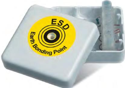
**Колодка** для заземления белая закрытая с резистором 1 МОм. В колодку может быть подключено до 5 заземляемых объектов. Габаритные размеры 60×60×30 мм. Имеет пять клемм: 4 клеммы на вход для подключения заземляемых объектов и 1 клемма на выход (защитную землю / Protected earth).
