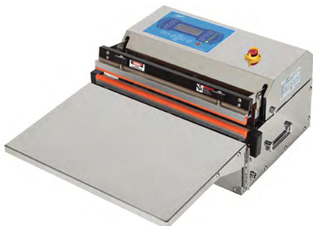
**Бескамерное** устройство для вакуумной упаковки VS-450E позволяет оперативно упаковывать промышленную продукцию различных размеров путем создания вакуума и заполнения упаковки газом через сопло, затем запечатывая вакуумные пакеты благодаря давлению сварочных планок и температуре нагревательного элемента.
