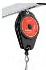
Предназначен для крепления инструментов, которые должны быть всегда под рукой. Подвес имеет подпружиненную катушку с намотанным на нее поддерживающим тросиком. Натяжение тросика регулируется в зависимости от веса инструмента. Крепится к инструментальной планке.
