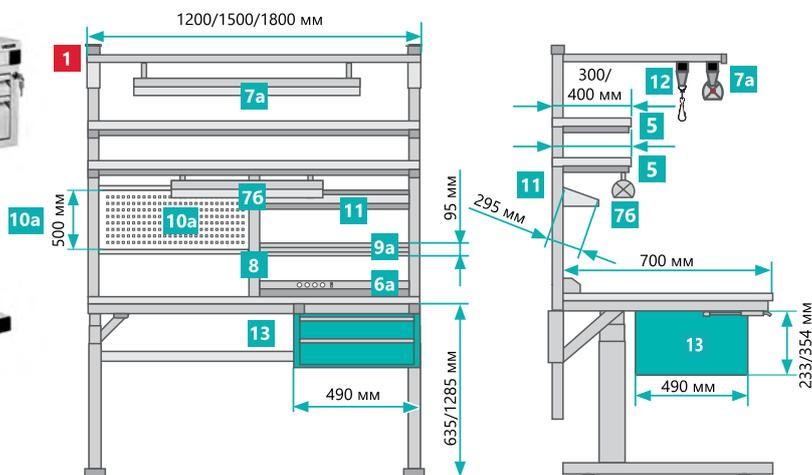
При заказе стола в ESD исполнении, необходимо заказать соединительную коробку и узел заземления.
