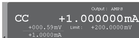
Установка значений источника питания с разрешением 6,5 разрядов. Измеренное значение тока/напряжения.
