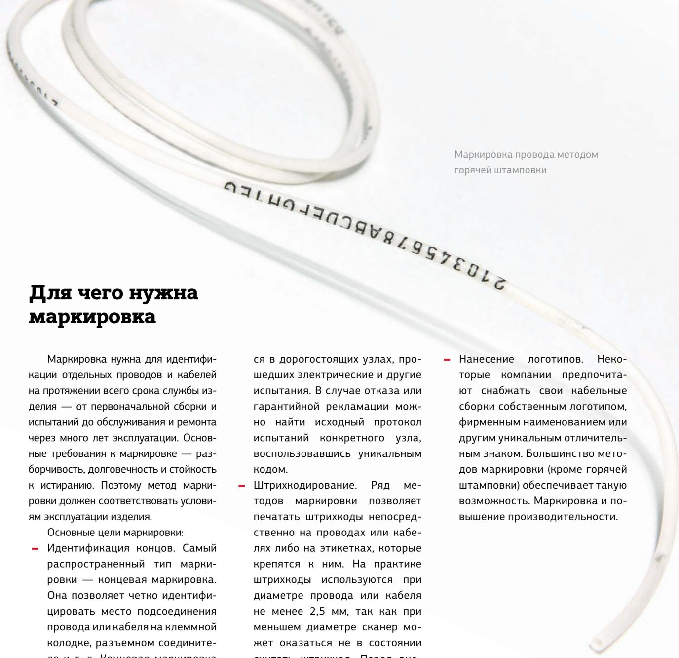
Маркировка провода методом горячей штамповки
