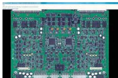
Снимок печатной платы в режиме реального времени при проведении оптического контроля
