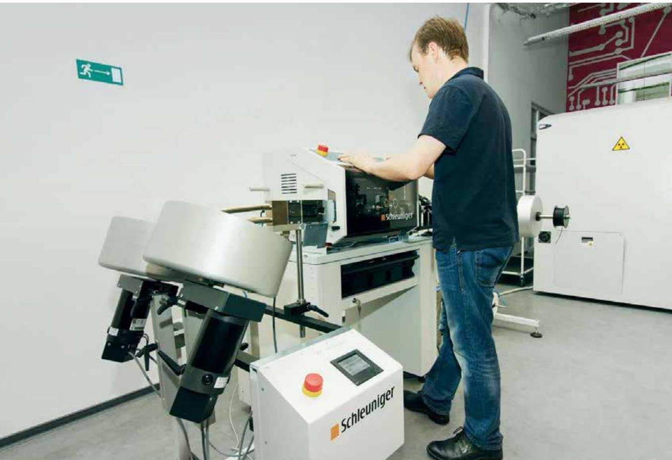
Автоматическая линия мерной резки, зачистки и нанесения маркировки на основе машины Omni Strip 9450
