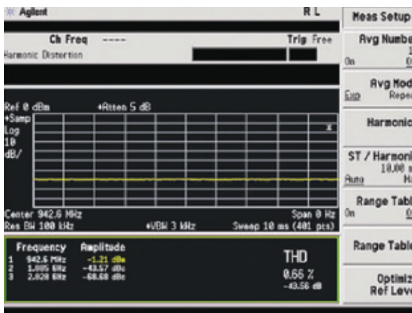
Измерение гармоник искаженного непрерывного (гармонического) сигнала частоты 1 ГГц
