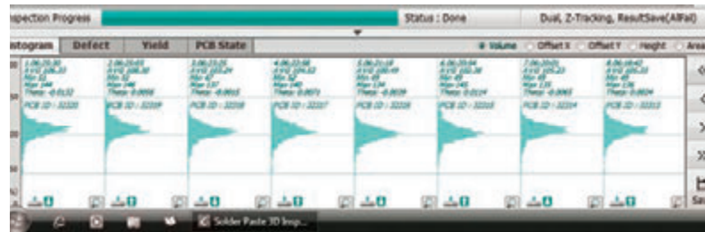
Рис. 6. Ряд последовательных гистограмм позволяет увидеть тенденцию изменения качества нанесения пасты
