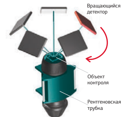
Рис. 6. Основной принцип частичной компьютерной томографии (компьютерной томографии плат большого размера, компьютерной томографии в ограниченном диапазоне углов)
