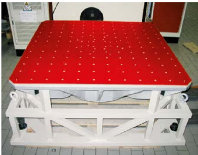
Расширительный стол 1000x1000 мм с системой поддержки – арматура 440 мм 2000 Гц Устанавливается на цапфу
