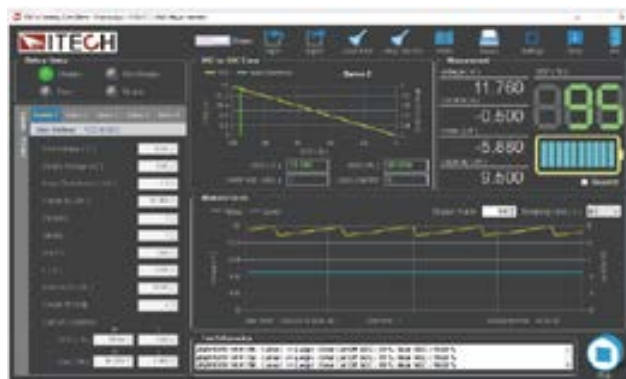
Интерфейс программного обеспечения для имитации аккумуляторных батарей BSS2000
