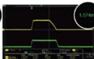
8 устройств IT6522C, соединенных параллельно Номинальное напряжение: 80 В Номинальный ток: 960 А Ток нагрузки: 300 А
