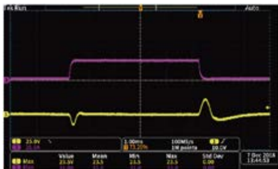
Отдельное устройство IT6006B-500-30 500 В 30 А 6000 Вт Настройка: напряжение 100 В, ток 28 А Ток нагрузки: 30 А
