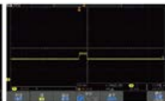
Тестирование преобразователя постоянного тока в постоянный на всплеск напряжения
