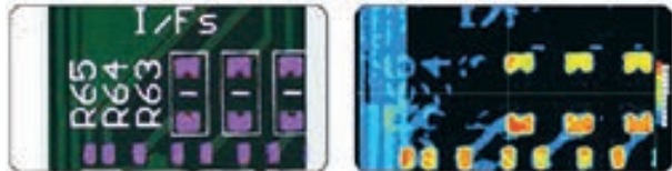
Определение избытка или малого объема паяльной пасты
