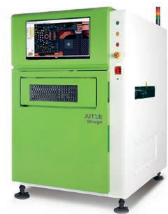
Показывает дефекты нанесения паяльной пасты в 3D на всей поверхности платы
