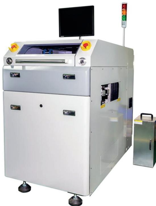
JT MIS – полностью автоматическая система селективной пайки.
