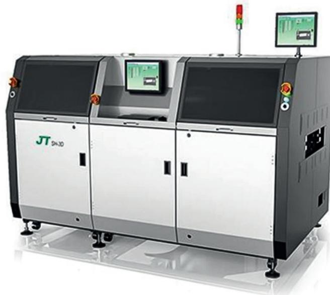
SH-3D – компактная и гибкая система селективной пайки. Все модули распложены внутри единой рамы и снабжены конвейером, что делает возможным интеграцию системы в линию.
