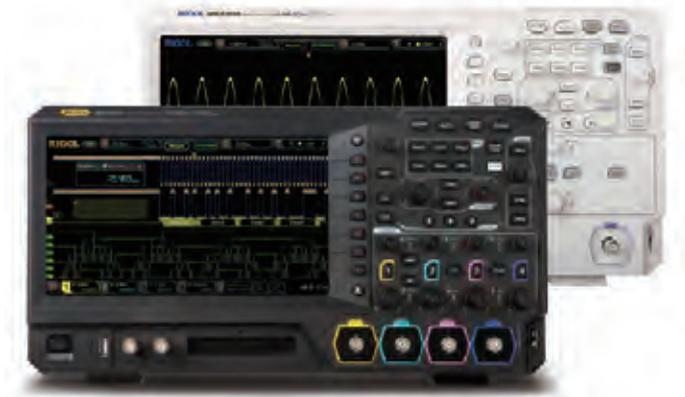
Цифровой осциллограф Rigol серии MSO5000 объединяет в одном корпусе до семи измерительных приборов: цифровой осциллограф, 16-канальный логический анализатор, двухканальный генератор сигналов, анализатор спектра, цифровой вольтметр, 6-разрядный частотомер, анализатор протоколов. Такая широкая функциональность достигается путём установки дополнительных опций, что позволяет применять осциллографы серии MSO5000 для решения многих измерительных задач.
