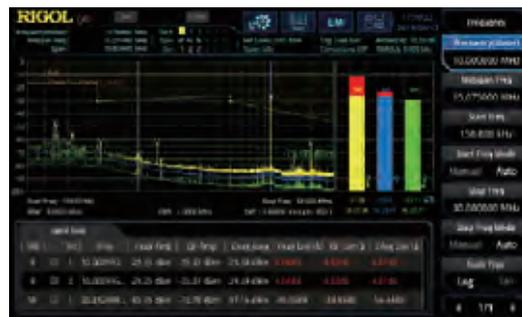
Встроенное прикладное программное обеспечение для предварительного тестирования на электромагнитные помехи с CISPR фильтрами.
