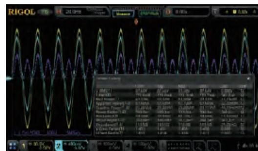
Осциллографы серий DS8000-R, MSO8000, MSO/DS7000 и MSO5000 поддерживают дополнительное встроенное программное обеспечение, которое может выполнять анализ качества электропитания и анализ пульсаций. Программное обеспечение призвано помочь инженерам быстро и точно проанализировать часто используемые параметры мощности без необходимости выполнять утомительную настройку вручную или выполнять сложные расчеты.
