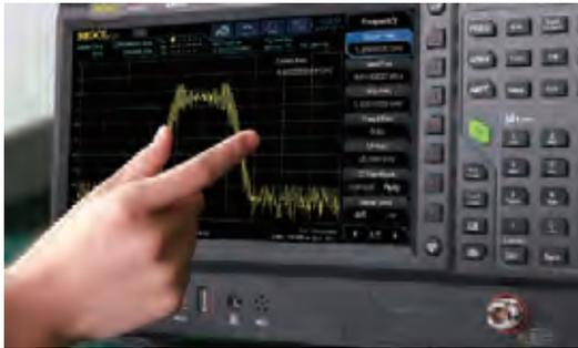
Использование сенсорного дисплея позволит проводить быструю настройку, а также осуществлять масштабирование, перетаскивание результатов измерения.
