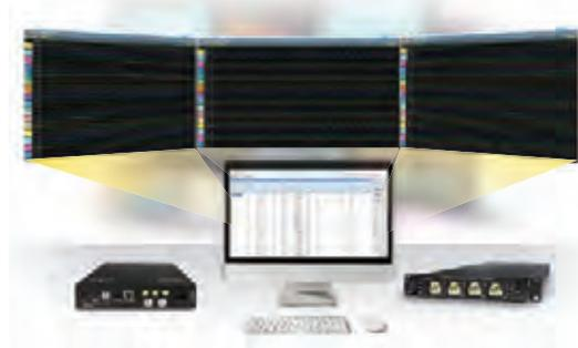
Программное обеспечение для многоканального сбора высокоскоростных данных может использоваться для настройки нескольких устройств, обеспечивая удобный интерфейс для отображения полученных сигналов каждого канала.
