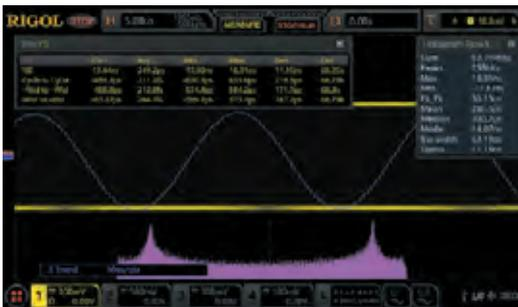
Измерение TIE для тактового сигнала с джиттером и анализ результатов измерения с помощью графика тренда и гистограммы
