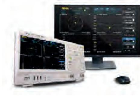
Анализатор спектра можно подключить к монитору большего размера через интерфейс HDMI. Возможно управление через web-интерфейс
