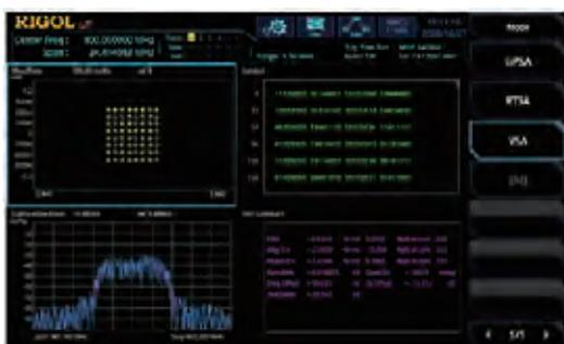
VSA поддерживает различные форматы цифровой модуляции, такие как QAM, PSK, MSK, ASK, FSK и т. д. Приложение используется для демодуляции и отображения различных данных, таких как созвездие, (сигнал основной полосы частот), спектрограмма, демодулированная последовательность и т. д..
