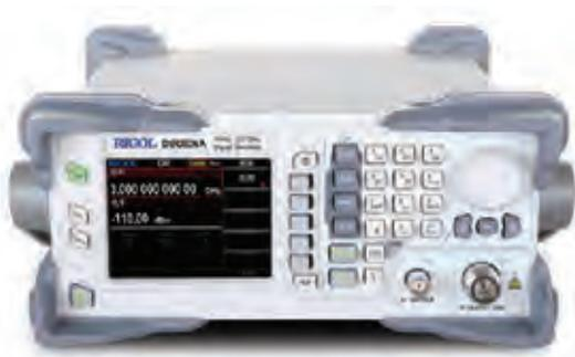
Генератор сигналов серии DSG800 способен формировать ВЧ сигнал в диапазоне частот от 9 кГц до 3,6 ГГц. В сочетании с бюджетным анализатором серии DSA800 можно решать различные измерительные задачи в области СВЧ.
