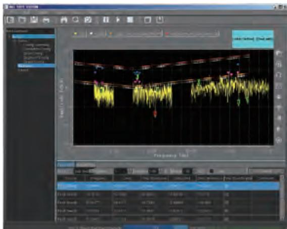
S1210 — это прикладное программное обеспечение для ПК, разработанное RIGOL для серий RSA5000, RSA3000/E, DSA800, DSA800E и DSA700 с опцией EMI-DSA800 для проведения предварительных испытаний на соответствие ЭМС
