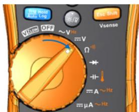
Чтобы включить мультиметр, поверните дисковый переключатель в любое другое положение.
