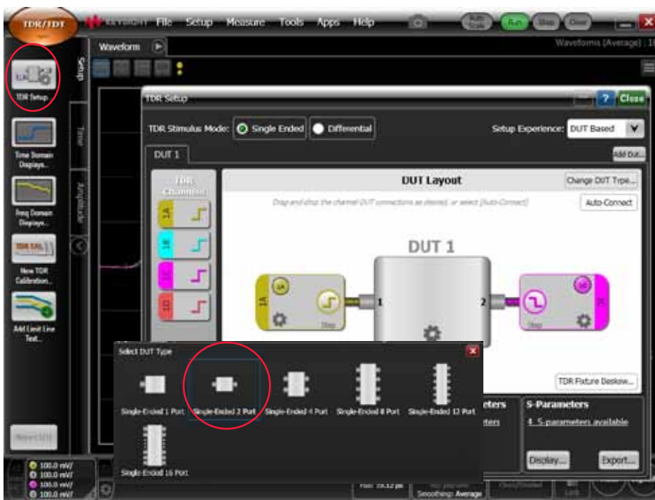
Рисунок 28. Экран настройки рефлектометра для TDR/TDT-измерения.
