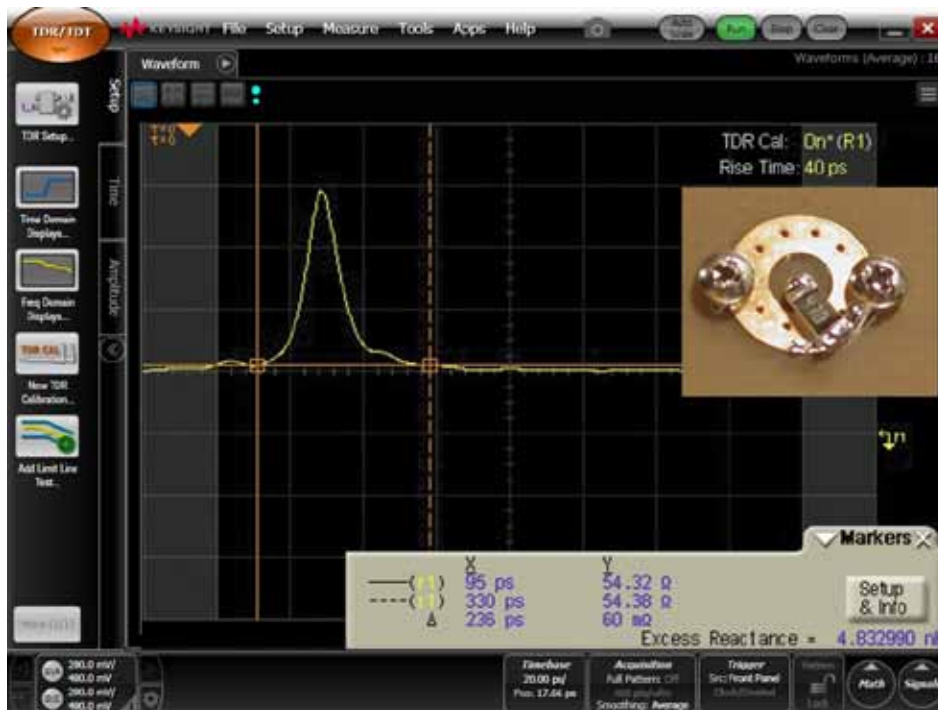
Рисунок 22. Применение маркеров для извлечения избыточной индуктивности SMT резистора согласованной нагрузки, установленного на тестовой плате MCW620.
