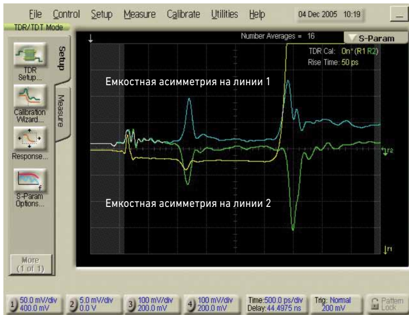
Рисунок 63. Измеренное преобразование режима в дифференциальной паре, когда емкостная неоднородность переходит с одной линии на другую.
