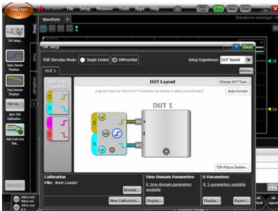
Рисунок 50. Экран настройки DTDR для дифференциальных измерений.
