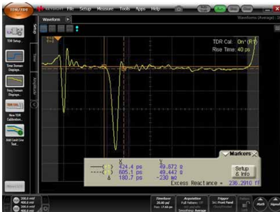
Рисунок 16. Применение функции избыточной реактивности для извлечения ёмкости контрольной площадки.
