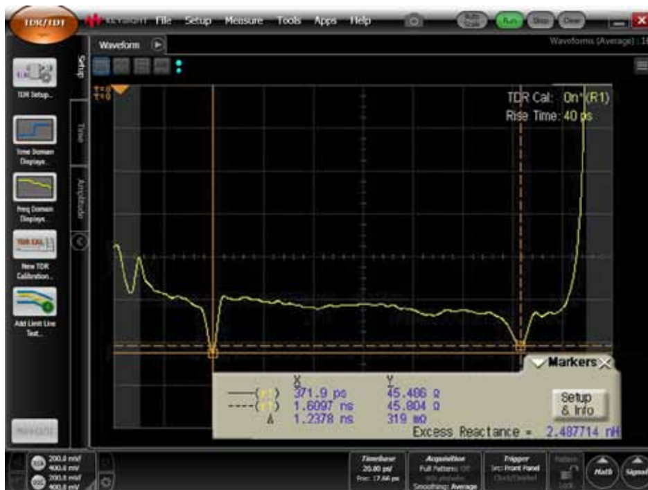
Рисунок 10. Рефлектограмма микрополосковой линии с двумя контрольными площадками, и применение маркеров для измерения задержки прохождения в обе стороны.
