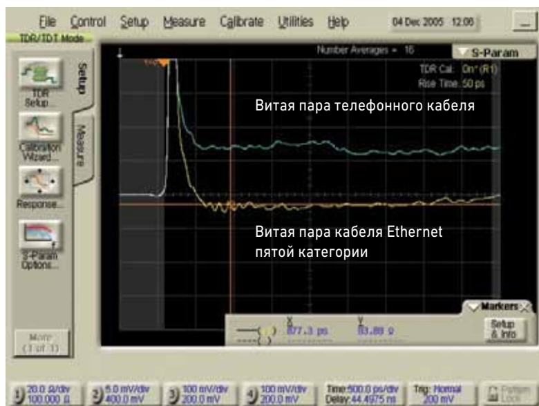
Рисунок 58. Измеренный дифференциальный импеданс двух разных витых пар, подключенных к коаксиальному разъёму.
