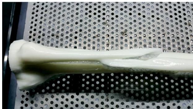
Рис. 3. Результат — 3D-модель кости с переломами на лотке для печати после завершения процесса ее изготовления
