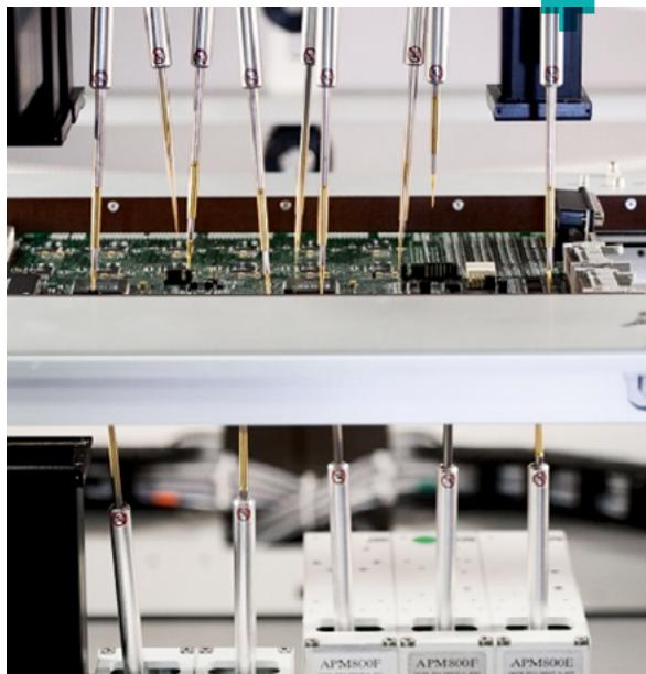
Рабочая зона комплекса. Процесс двустороннего тестирования печатного узла
