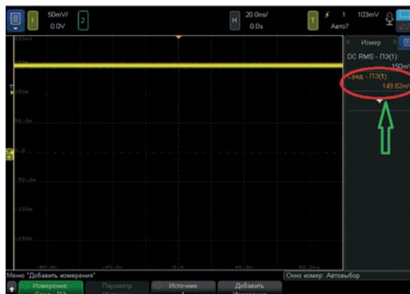
Рис. 1. Осциллограмма измерения постоянного напряжения осциллографом Keysight DSOX6002A
