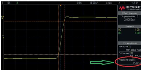
Рис. 3. Осциллограмма измерения времени нарастания испытательного импульса осциллографом Keysight MSO-X2012A
