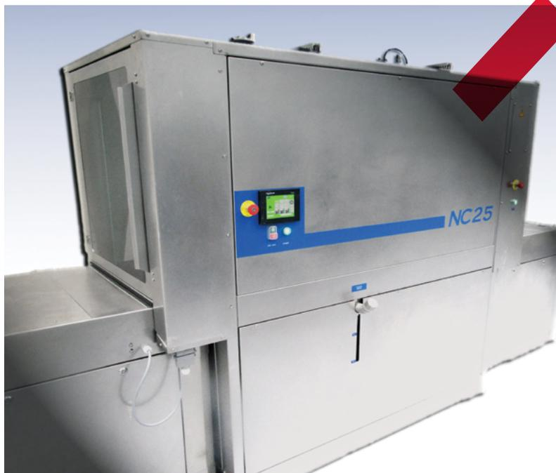
Установка отмывки печатных плат NC25 с функцией автоматической загрузки и разгрузки рамок с изделиями NC25 AL
