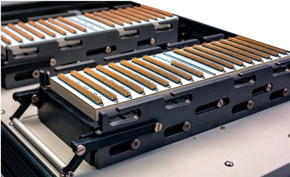
Рис. 4. Прецизионное прижимное устройство измерительного блока
