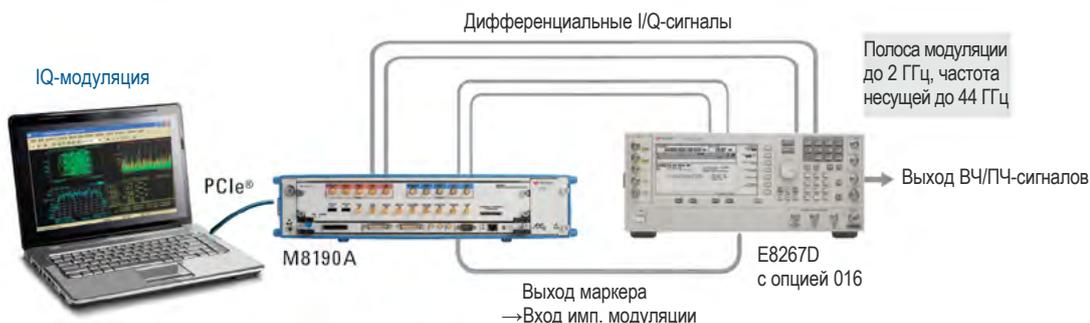
Структурная схема, приведённая ниже, содержит конфигурацию для I/Q-модуляции и непосредственного вывода ПЧ/ВЧ-сигналов. M8190A поддерживает формирование ПЧ-сигналов цифровыми методами, что гарантирует высочайшее качество сигналов. Прибор обеспечивает аналоговую полосу частот 5 ГГц; если требуется более широкая полоса частот, к этой конфигурации нужно добавить смеситель.
