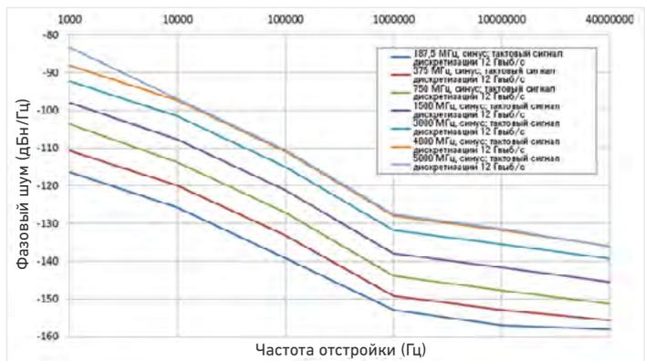
График фазового шума, внешний тактовый сигнал дискретизации 12 Гвыб/с, измерено на прямом выходе с помощью симметрирующего устройства
