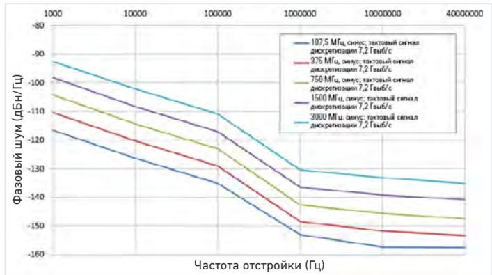
График фазового шума, внешний тактовый сигнал дискретизации 7,2 Гвыб/с, измерено на прямом выходе с помощью симметрирующего устройства
