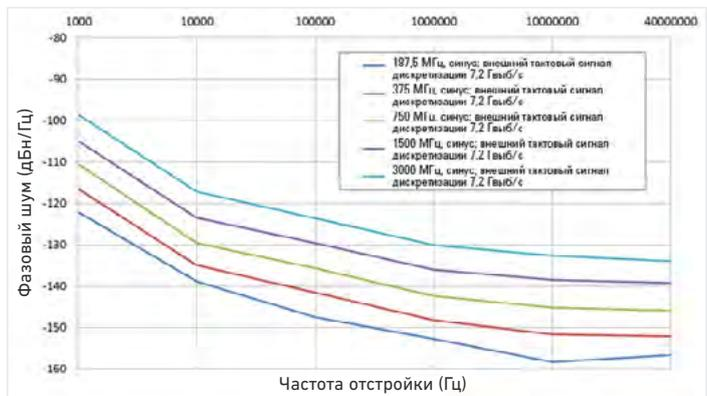
График фазового шума, внутренний тактовый сигнал дискретизации 12 Гвыб/с, измерено на прямом выходе с помощью симметрирующего устройства
