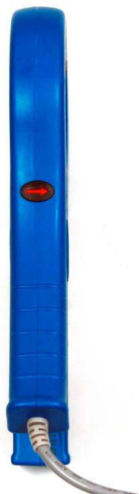
Рисунок А.8 - Расположение маркировки «генератор → нагрузка» на токоизмерительных клещах 1000А.
