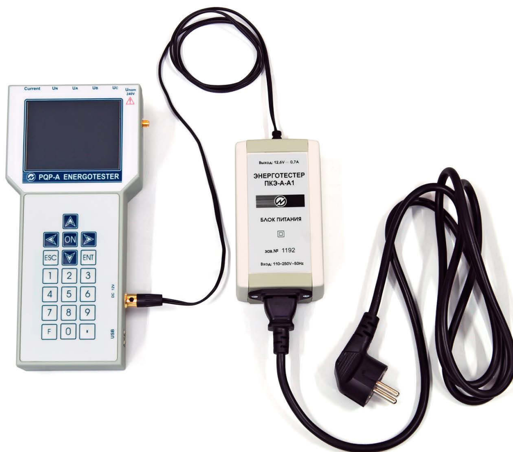
Рисунок Б1 - Схема подключения питания Энерготестера ПКЭ-А через сетевой адаптер
