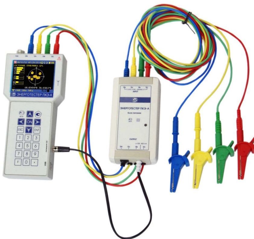
Рис. 3.2а. Подключение Энерготестера к адаптеру универсальному.
