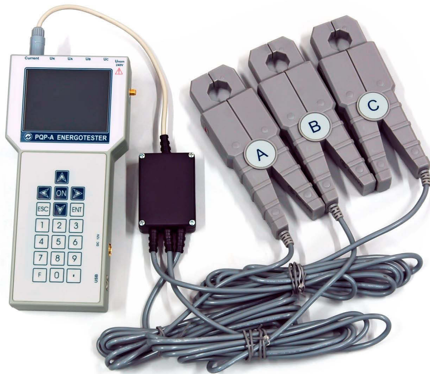
Рисунок А.3 - Схема подключения токоизмерительных клещей 100А к Энерготестеру ПКЭ-А.
