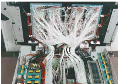
Рис. 5. Соединительные провода в традиционном адаптерном тестере
