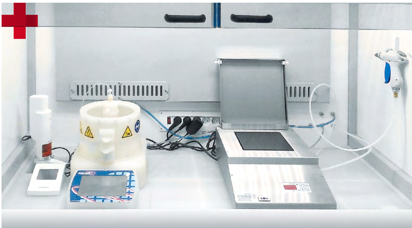
Вытяжной шкаф с оборудованием для нанесения и сушки фоторезиста
