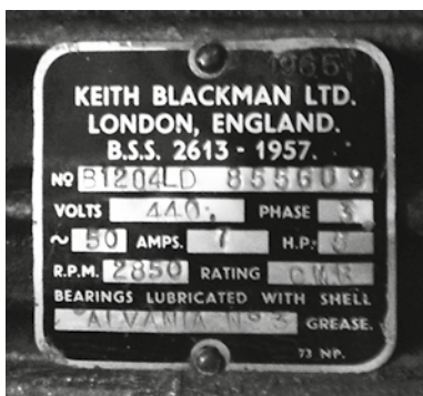
Рис. 3. Шильд мотора вентилятора охлаждения с указанием года изготовления
