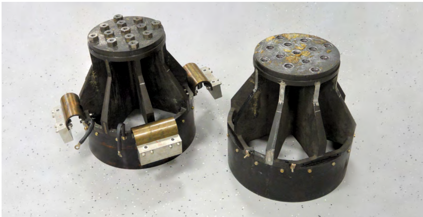
Рис. 8. Слева — новая подвижная катушка с установленными элементами подвески, справа — отработанная подвижная катушка
