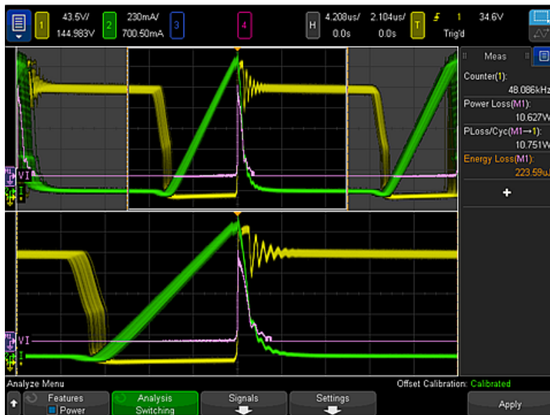
Рисунок 2. Измерение потерь мощности и энергии в силовом ключе
