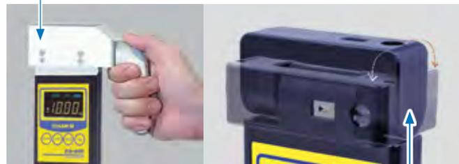
Измерения с помощью поворотной головки
