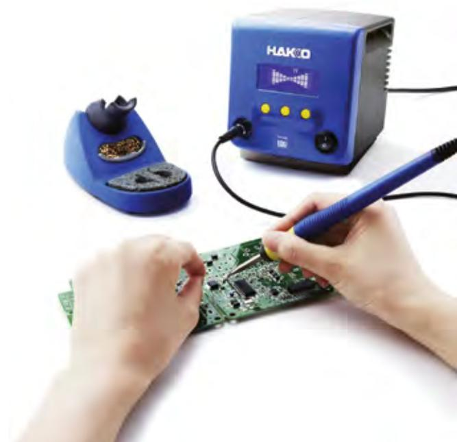
Уникальная технология FX-100 обеспечивает высокую скорость разогрева наконечника за счет быстро изменяющегося магнитного поля. В проводнике (в данном случае наконечнике паяльника) возбуждается электрический ток, который и вызывает быстрый нагрев.
