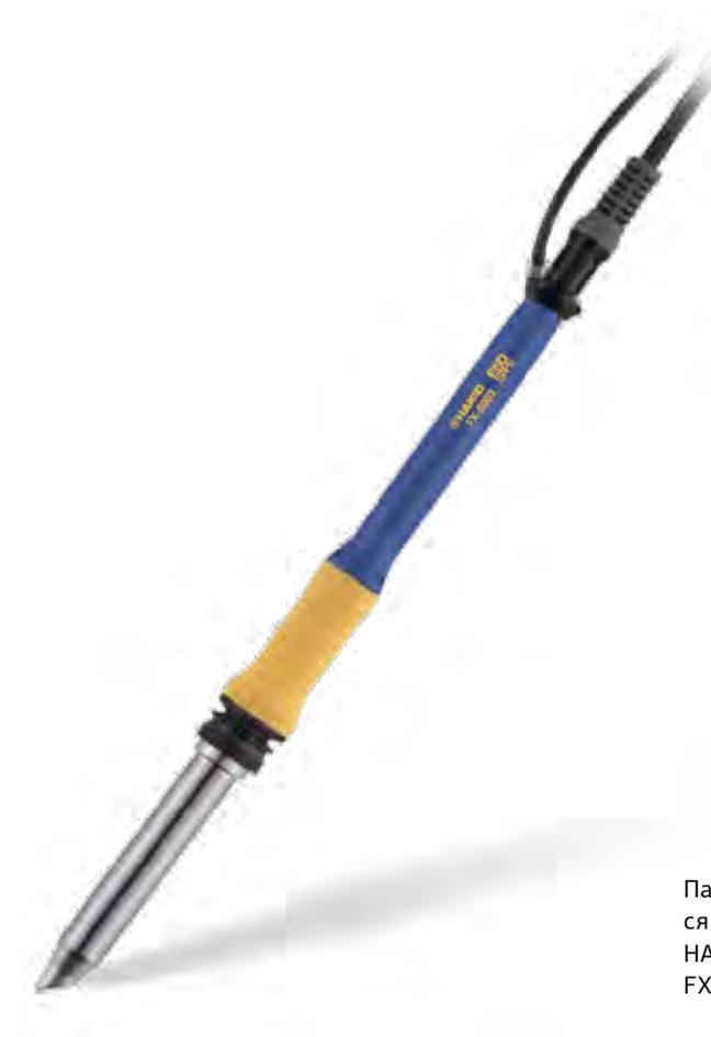
300-ваттный паяльник с мощным тепловым восстановлением, использующий предварительно нагретый изолирующий газ азот, что позволило существенно улучшить процесс пайки, а также уменьшить дефекты пайки за счет предотвращения окисления
