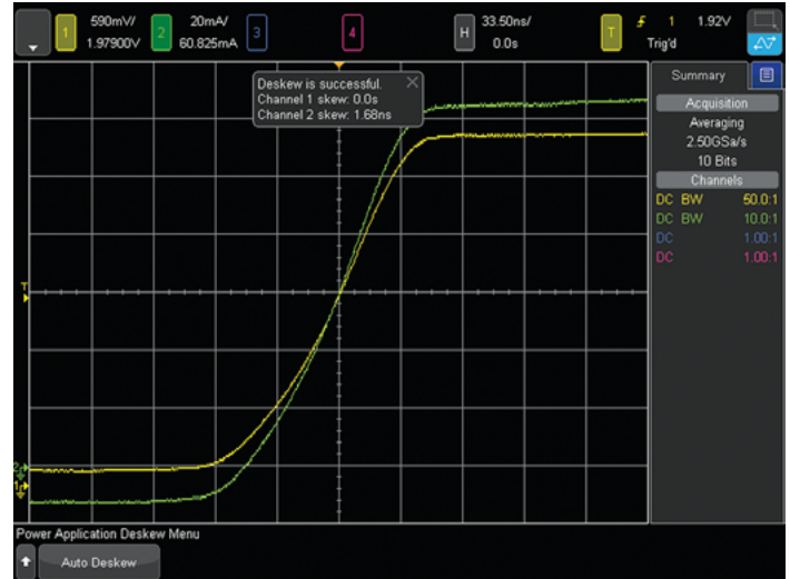
Рис. 13. Для получения точных результатов измерения параметров мощности крайне важно скомпенсировать временную задержку между пробниками напряжения и токовыми пробниками.
