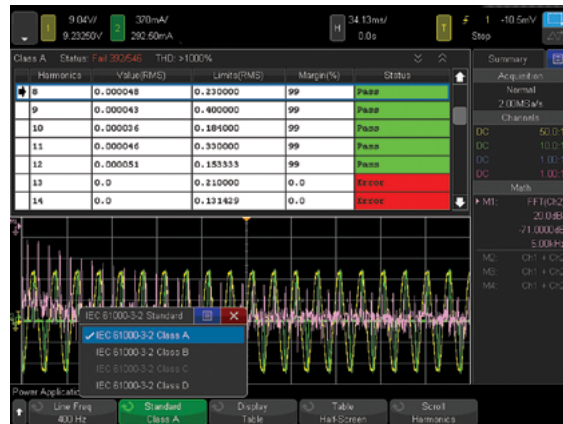
Рис. 2. Предварительная проверка источника питания на соответствие стандартам IEC 61000 3-2 по гармоникам. При таком анализе отображается до 40 гармоник.
