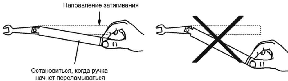
Рисунок 3-7 Использование динамометрического ключа
