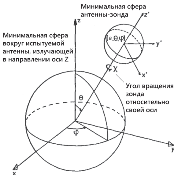
Рис. 6. Схема измерений АФР ортогональных составляющих E_\theta и E_\varphi тангенциальной составляющей E на сферической поверхности
