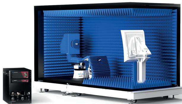
Рис. 2. Компактный полигон на основе радиоколлиматора: измерительное оборудование и малогабаритная БЭК с коллиматором и позиционерами для облучателя коллиматора и ИА (изображение с сайта компании NSI-MI Technologies)
