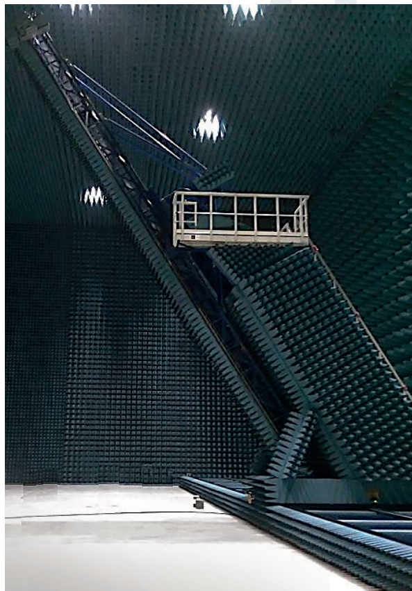
Рис. 8. Вертикальный башенный сканер с возможностью наклона башни: а) башня расположена вертикально; б) башня наклонена на 32^\circ к вертикали
