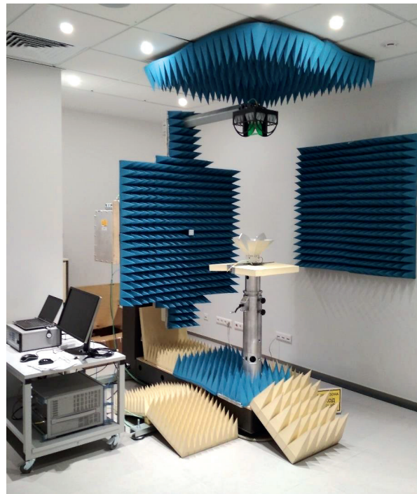
Рис. 10. Система TS8991: 1 — БАЦ; 2 — позиционер; 3 — антенна-зонд; 4 — эталонная антенна для калибровки или ИА; 5 — радиопоглощающий материал; 6 — ЭВМ; 7 — контроллер позиционера
