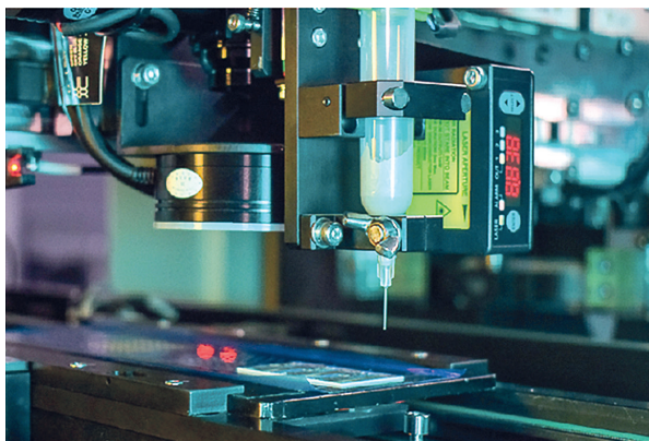
Рис. 2. Программируемый дозатор клея установки T18
