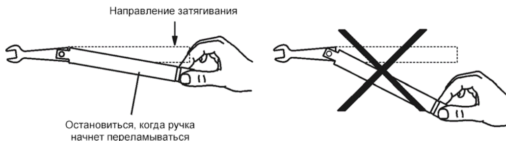
Рисунок 3-8 Использование динамометрического ключа
