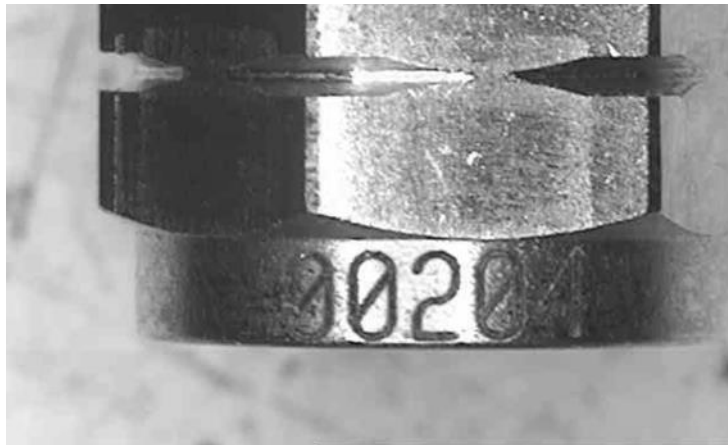
Рисунок 1-1 Серийный номер, выгравированный на гайке воздушной линии
