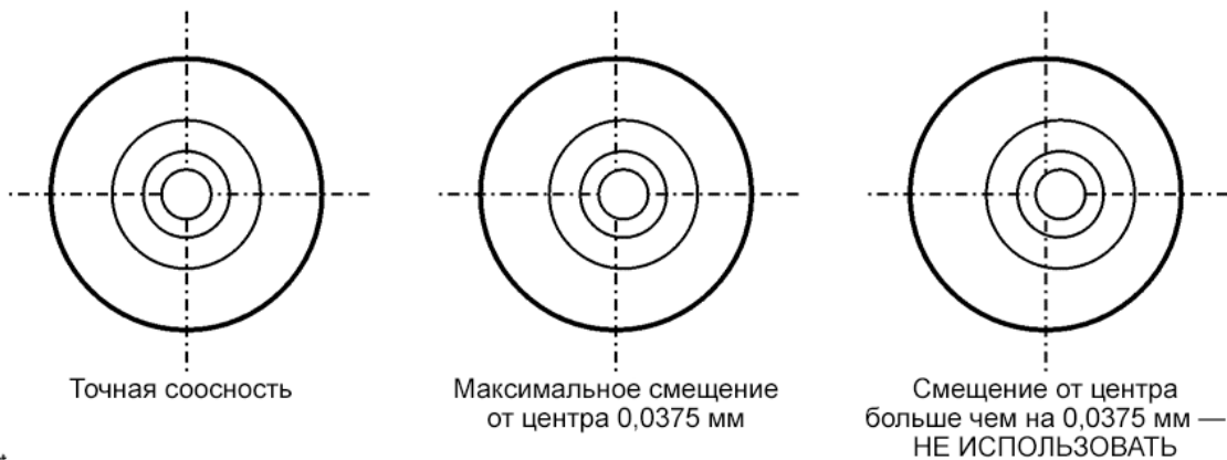
Рисунок 3-4 Соосность соединителя типа «вилка»
