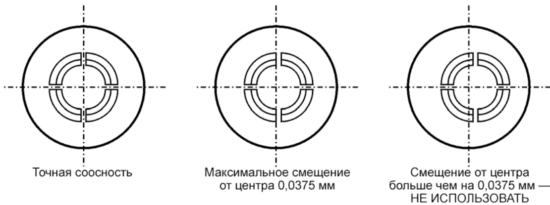
Рисунок 3-3 Соосность соединителя типа «розетка»
