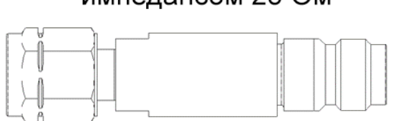
Линия с утолщением со ступенчатым импедансом 25 Ом
