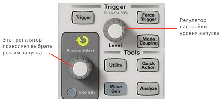
Рис. 20. Блок органов управления системой запуска осциллографа Keysight серии InfiniiVision 2000 X.
