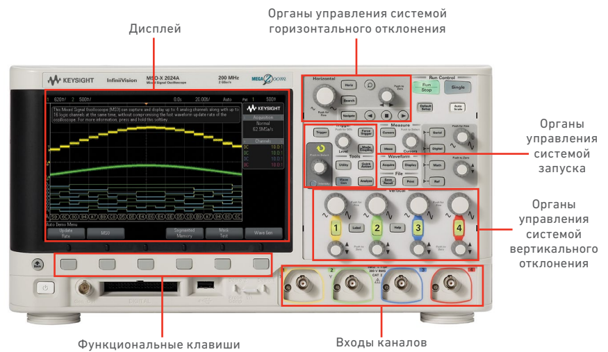
Рис. 8. Передняя панель осциллографа Keysight серии InfiniiVision 2000 X.
