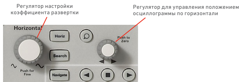
Рис. 17. Блок органов управления системой горизонтального отклонения осциллографа Keysight серии InfiniiVision 2000 X.
