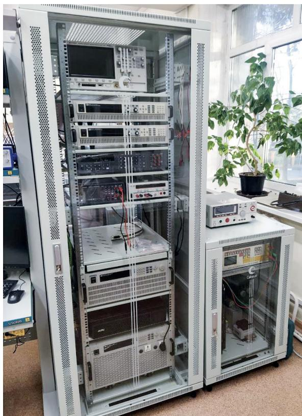
*Автоматизированное рабочее место для проверки источников питания на базе ПО METLAB*
