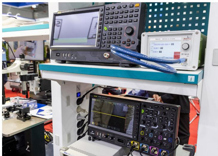
Также мы демонстрировали новую серию 8-канальных осциллографов **DHO5000** компании Rigol. Это первая в мире линейка 12-битных осциллографов с полосой пропускания до 1 ГГц и возможностью работы от источника автономного питания.
