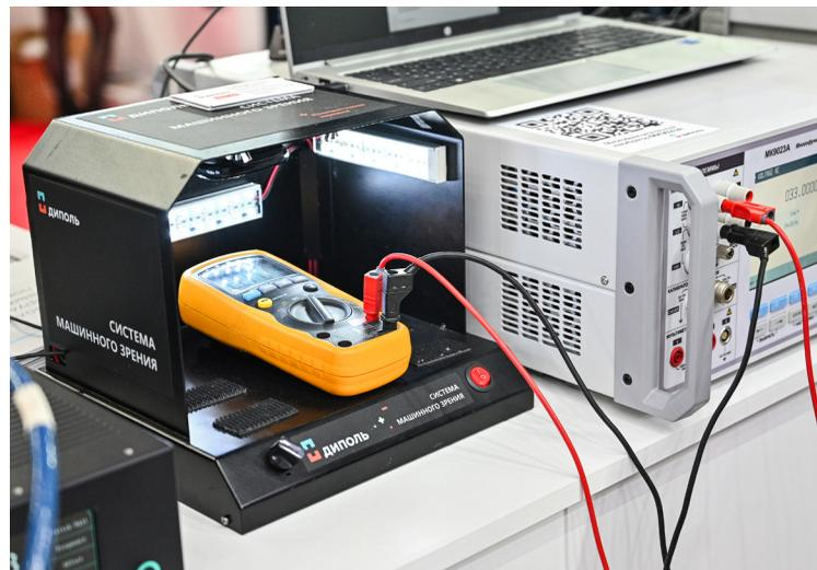
Как всегда на таких выставках, мы демонстрировали возможности автоматизированной проверки ручного мультиметра с помощью **ПО METLAB** и модуля машинного зрения **DigitMeterVision**. В этом году посетители могли оценить ряд новых возможностей METLAB, например создание более гибкого протокола проверки или способность прерывать измерения и продолжать их позже.
