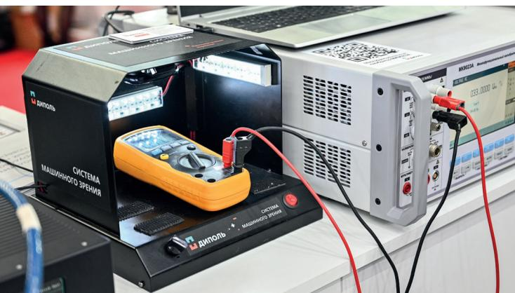
Для стабильного освещения поверяемых средств измерений используется короб с подсветкой (возможны другие варианты фиксации приборов и освещения)
