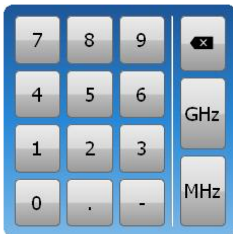
Рисунок 7.35 – Клавиатура ввода частоты измеряемого сигнала
