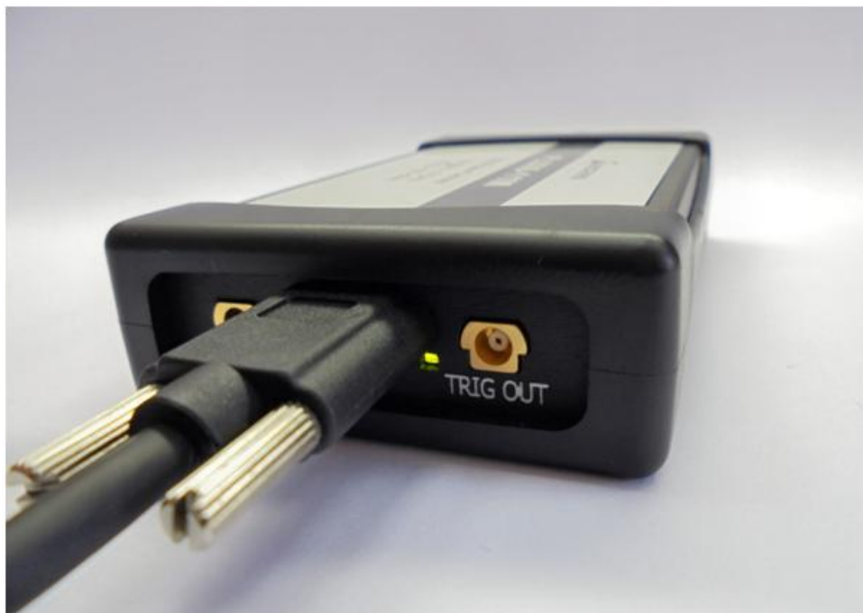
Рисунок 7.4 – Измеритель мощности PLS06 готов к работе
