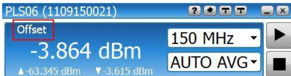
Рисунок 7.15 – Отображение результатов измерения мощности с индикацией математического смещения
