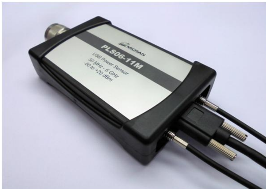
Рисунок 7.3 – Измеритель мощности PLS06 с подключенным USB кабелем и кабельными сборками синхронизации MCX-BNC
