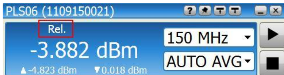
Рисунок 7.16 – Отображение результатов измерений мощности с индикацией использования опорного уровня
