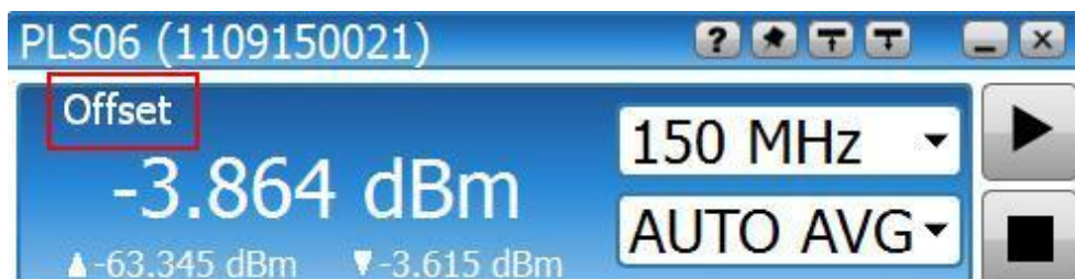
Рисунок 7.26 – Индикация математического смещения результатов измерений в основном окне ПО PLS-Client
