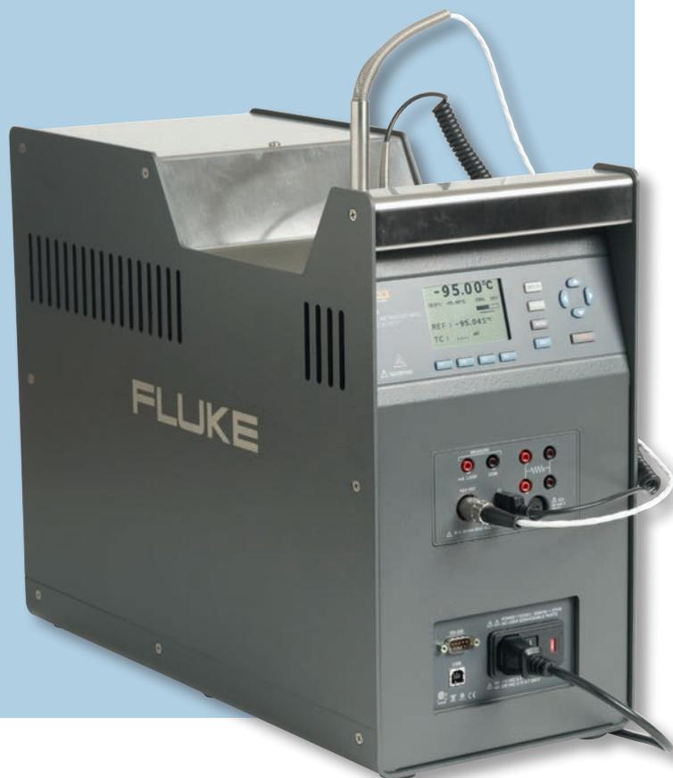
Сухоблочный калибратор для сверххолодной зоны 9190A обеспечивает превосходную стабильность, унификацию и достаточную глубину скважины для калибровки платиновых эталонных термометров (PRT), термопар и других термометров промышленного назначения. Точность отображения для комплекса 9190A составляет  $\pm 0,2$  °C во всем диапазоне. Применение отраслевого стандарта TUR версии 4:1 позволяет добиться точности калибровки  $\pm 0,8$  °C с использованием только сухоблочного метода.
