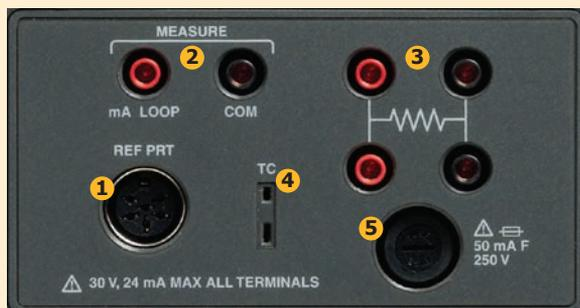
**Панель –P (технологическая версия) для комплекса 9190A. Выпускается только для вариантов конфигурации –P (например, 9190A-A-P).**
