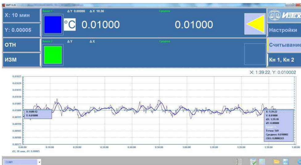
График температурного хода в ампуле тройной точки воды АТТВ-1, измеренного при помощи ПТС-10М (ток питания 1мА) и МИТ 8.20. СКО измерений составило 0.024мк.
