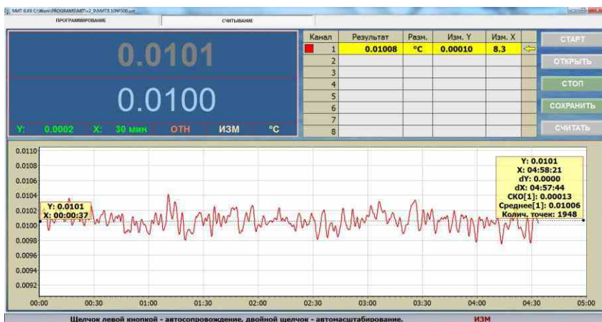
График температурного хода в ампуле тройной точки воды АТТВ-1, измеренного при помощи ПТС-10М (ток питания 1мА) и МИТ 8.15. СКО измерений составило 0.13мкК.
