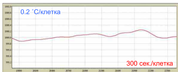
График хода температуры в калибраторе температуры КТ-3 с регулятором РТП-8.3 в зависимости от времени. ТП (ТНН) в качестве датчика температуры.
