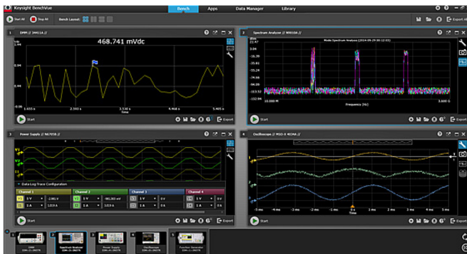
Рисунок 4. Интерфейс программы BenchVue, соединенной с четырьмя приборами
